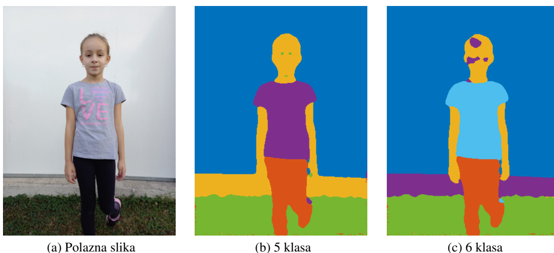
Slika 5.2: Segmentacija slike u različite brojeve segmenata (parametri su c = 0.02 , \sigma = 1.5\|x - y\|_2^2 , gdje su x i y prvi i središnji piksel, r = 30 , k = 5 ).
