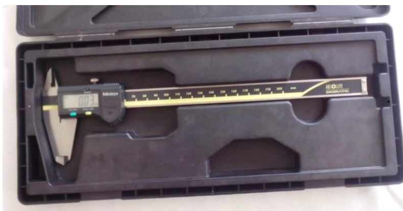
Slika 8. Digitalno pomoćno mjerilo (raspona 0 do 15 cm, preciznosti 0,05 mm)
