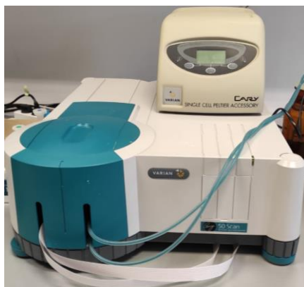
Slika 13. Prikaz instrumenta za spektrofotometrijsko određivanje spektara, Varian Cary 50 UV-Vis , otopine polielektrolita P4VP-a množinskih koncentracija navedenih u tablici 1.
