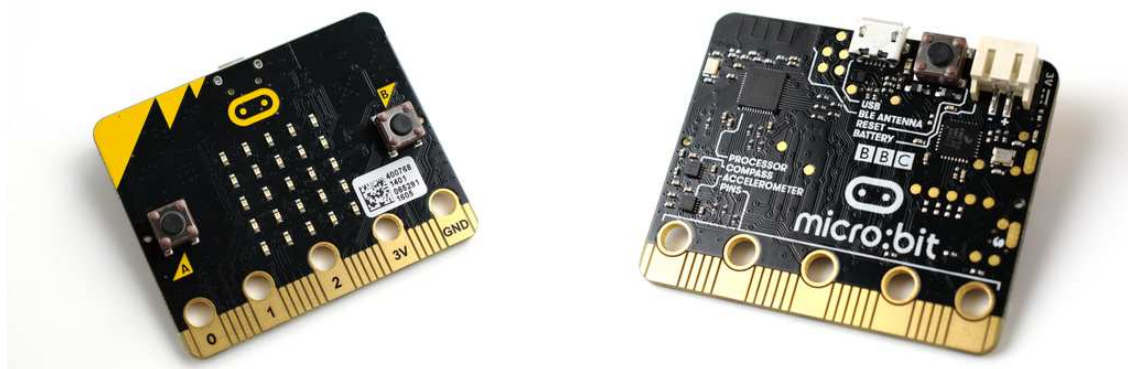
Slika 2.6: Micro:bit v1 prednja i stražnja strana (izvor lijevo: https://commons.wikimedia.org/wiki/File:BBC_micro_bit_(2614639942).png , desno: https://commons.wikimedia.org/wiki/File:BBC_micro_bit_(26212930836).png )
