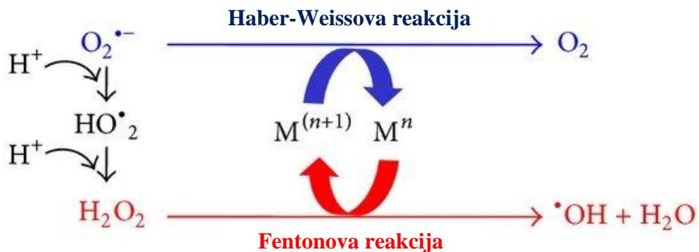
**Slika 3.** Shematski prikaz Fentonove i Haber-Weissove reakcije. Kratice: okisdirana forma prijelaznog metala – M<sup>(n+1)</sup>, reducirana forma prijelaznog metala - M<sup>n</sup>, hidroperoksilni radikal - HO<sup>·2</sup> (preuzeto i prilagođeno iz Ayala *i sur.*, 2014)
