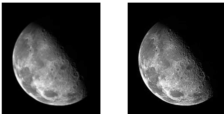
Slika 3.11: Slika mjeseca prije i nakon izoštravanja Laplacianom. Rezultat filtriranja s 3.10b je oduzet od originalne slike. Slika na lijevoj strani je preuzeta iz [35].
