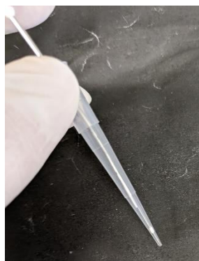
Slika 21. Prikaz nanošenja C18 materijala ( C18 Solid Phase Extraction Disks, Empore ) na vrh plastičnog nastavka za pipetu (engl. stage tip ). A) Šupljom iglom utisne se dvaput u C18 materijal koji zaostaje unutar igle i zatim B) se nanese na vrh plastičnog nastavka za pipetu od 2-200 \mu\text{L} .
