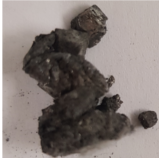
(b) Neobrađeni produkt sinteze \text{YbMnBi}_2 .
