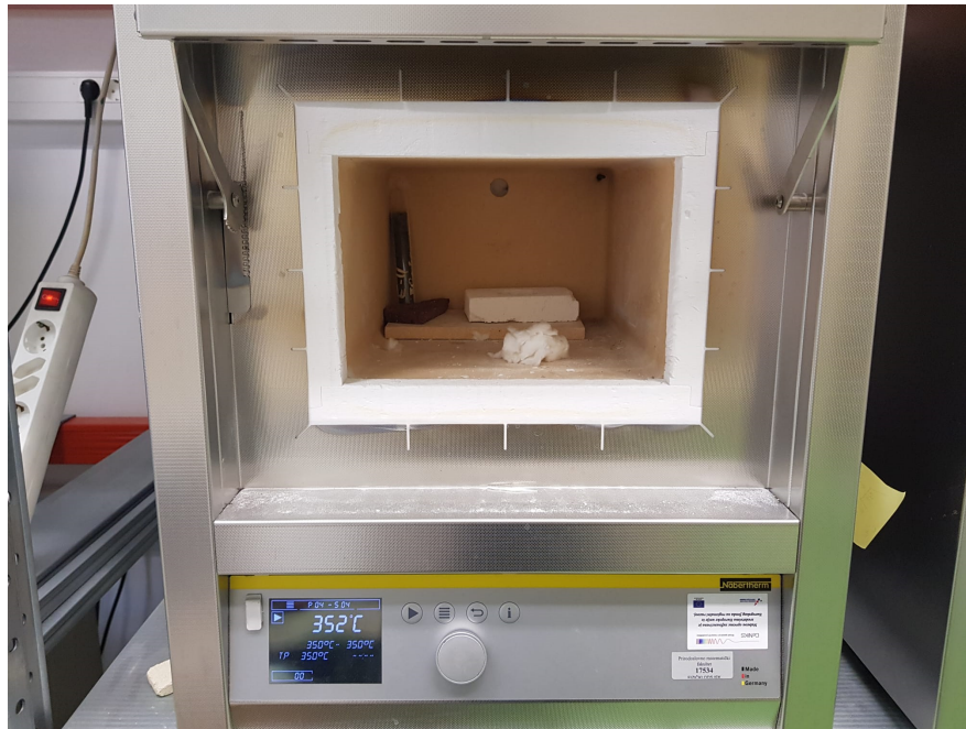
Slika 4.6: Slika mufolne peći za rast kristala. Peć je elektronički upravljana s finom regulacijom temperature te može doseći temperaturu do 1200 °C.
