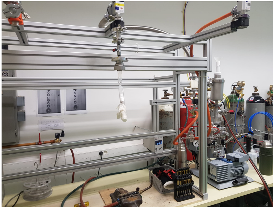
Slika 4.5: Radna stanica za vakuumsko zataljivanje kvarcnih cijevi. Kvarcne cijevi se zataljuju pomoću plamena nastalog miješanjem kisika i smjese propana i butana.
