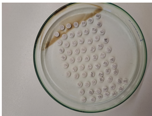
Slika 3.1: Dozimetri TLD-700 u Petrijevoj zdjelici.
