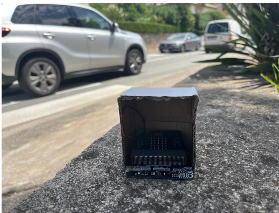
Slika 33 Micro:bit sa priključenim enviro:bitom u hladu uz prometnicu
