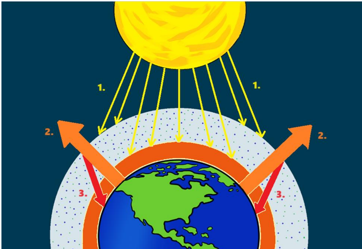
Slika 2 Vizualni prikaz učinka staklenika: 1. Sunčevo zračenje prolazi kroz atmosferu i dolazi do Zemlje. 2. Dio apsorbirane energije emitira se u svemir u obliku infracrvenog zračenja. 3. Staklenički plinovi u atmosferi apsorbiraju dio tog infracrvenog zračenja i potom ga ponovno emitiraju prema Zemljinoj površini i atmosferi.
