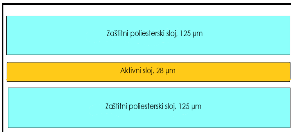
Slika 3.2: Shematski prikaz poprečnog presjeka GafChromic EBT3 filma.
