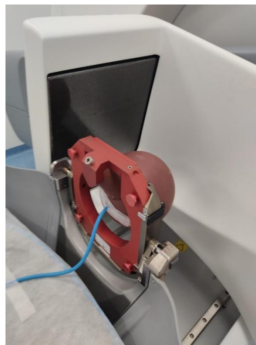
Slika 5.8: Leksellov gama nož sa ionizacijskom komorom i fantomom Solid Water, CBCT skener se nalazi u spušenom položaju (lijevo), fiksirani fantom i ionizacijska komora (desno).
