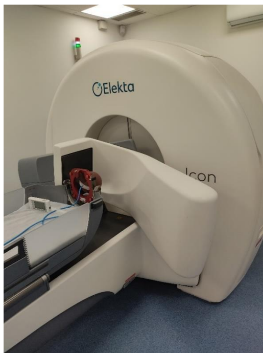
Slika 5.8: Leksellov gama nož sa ionizacijskom komorom i fantomom Solid Water, CBCT skener se nalazi u spušenom položaju (lijevo), fiksirani fantom i ionizacijska komora (desno).
