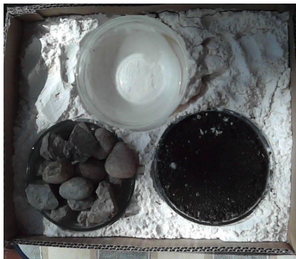
Slika 4.1: Postav pokusa: Zagrijavanje jednako osvijetljenih površina
