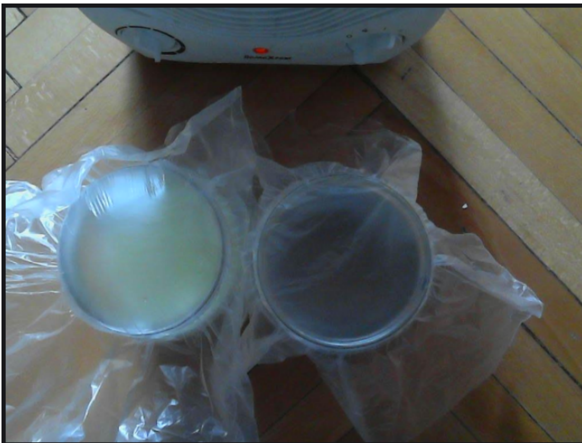
Slika 4.16: Postav pokusa 3: Utjecaj povećane koncentracije CO 2 na zagrijavanje i hlađenje
