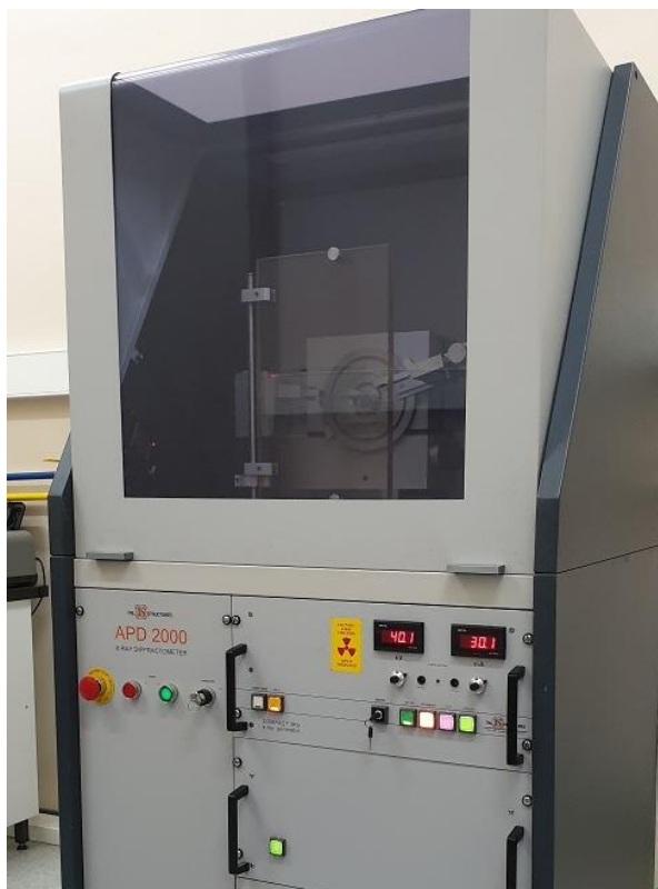
Slika 4.8. Rendgenski difraktometar Italstructures APD 2000
