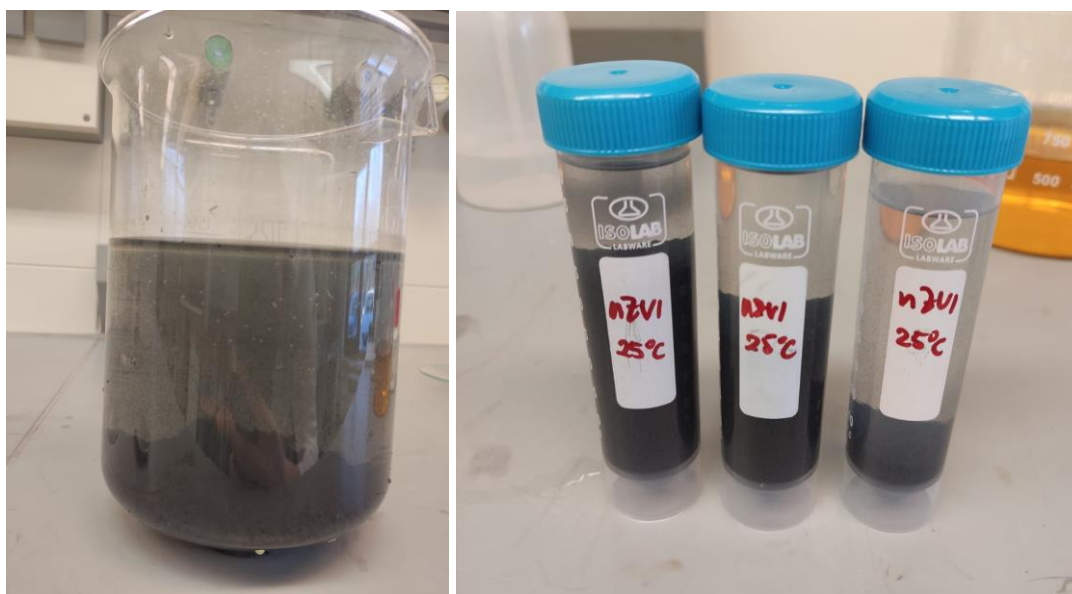
Slika 14. Reakcijska posuda s istaloženim nanočesticama željeza (lijevo) i nanočestice željeza pohranjene u spremnike do vrha napunjene etanolom (desno)
