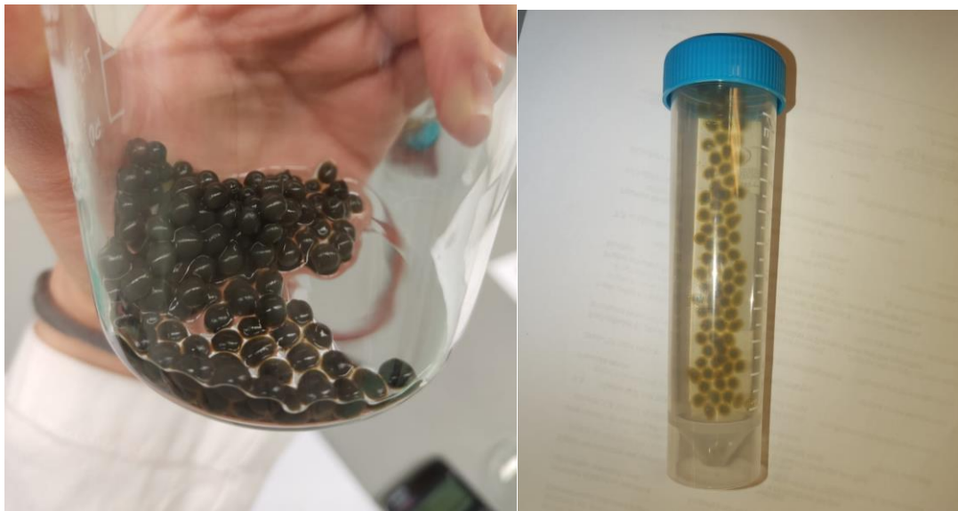
Slika 15. Inkapsulirane nanočestice željeza neposredno nakon inkapsulacije (lijevo) i nakon 24h pohrane u plastičnom spremniku s etanolom (desno)
