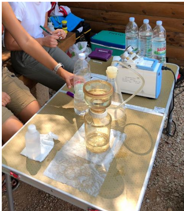
Slika 11. Filtriranje uzoraka vode na Whatman GF/F filterima (Sigma Aldrich, UK).
