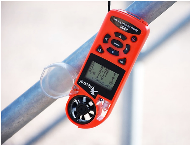
Slika 13. Mjerenje mikroklimatskih parametara uređajem Kestrel 4000 pocket weather tracker
