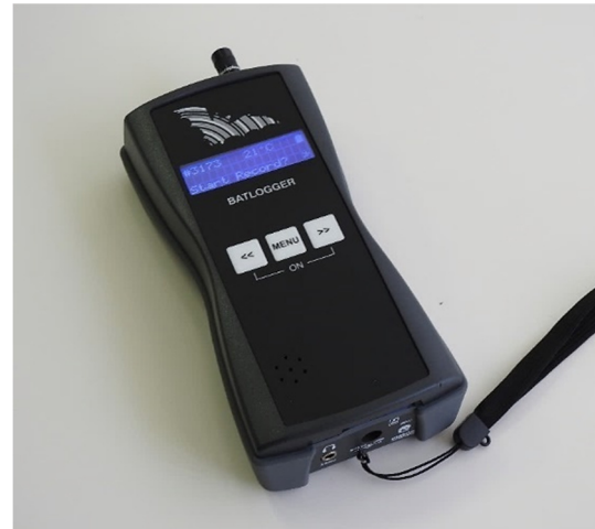
Slika 14. Ultrazvučni detektor (bat detektor) Elekon BATLOGGER M
