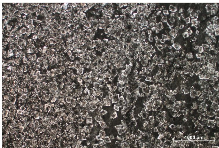
Slika 26 Fotomikrografija dolomitiziranog vapnenca na kojoj se vide kristali dolomita (uzorak 6).
