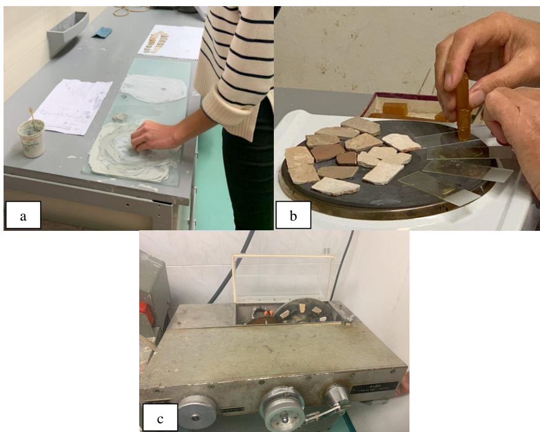
Slika 7 a) Poliranje pločica pomoću korundovog praha finoće 500 i malo vode; b) Sušenje i lijepljenje pločica na predmetna stakalca; c) Strojno stanjivanje pločica.
