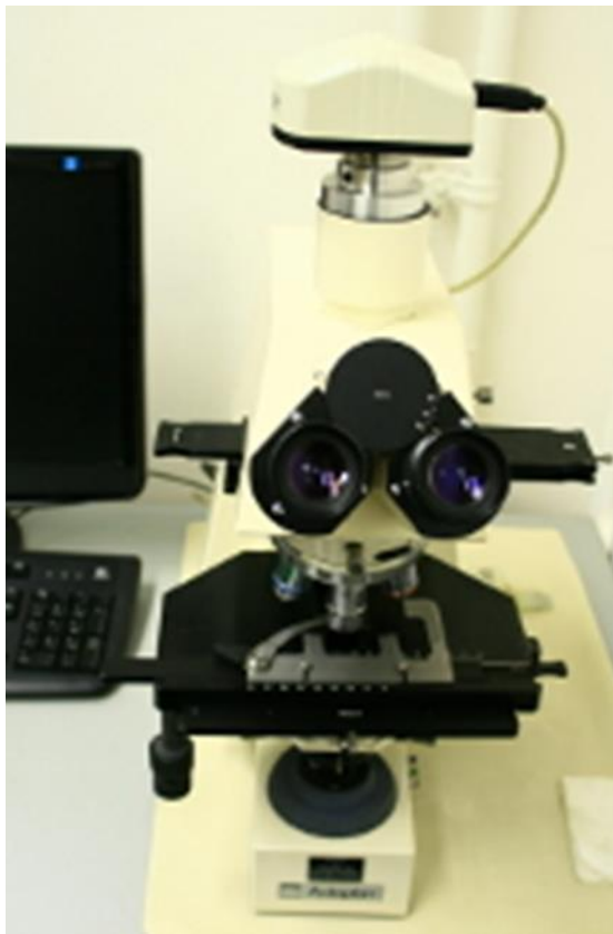
Slika 15. Polarizacijski mikroskop proizvođača Opton Axioplan korišten u izradi diplomskog rada; povećanja do 100x čija je primjena vezana uz mikropaleontološke analize [3]
