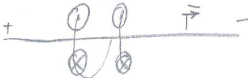
Slika 33. Prikaz smjera magnetskog polja (kružići s znakom X i točkice) ravnog vodiča u ovisnosti o smjeru struje I ravnog vodiča.
