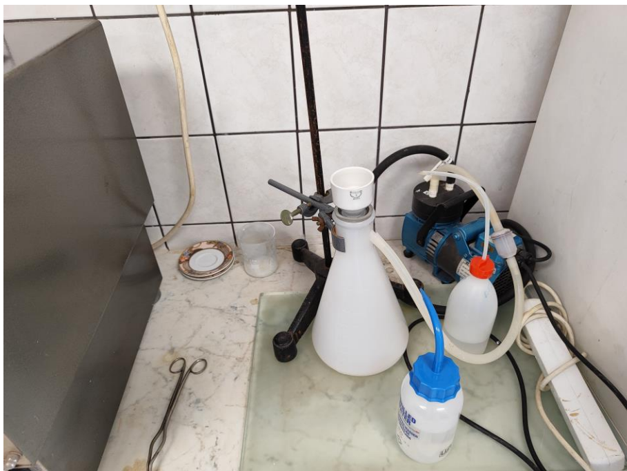
Slika 7 Aparatura za filtriranje čestica mikroplastike. Filter papir u keramičkom nosaču na plastičnoj tikvici za skupljanje SPT-a spojenoj na pumpu koja stvara vakuum. Slikano u laboratoriju Mineraloško-petrografskog zavoda PMF-a. Fotografija: Karl Bičanić.
