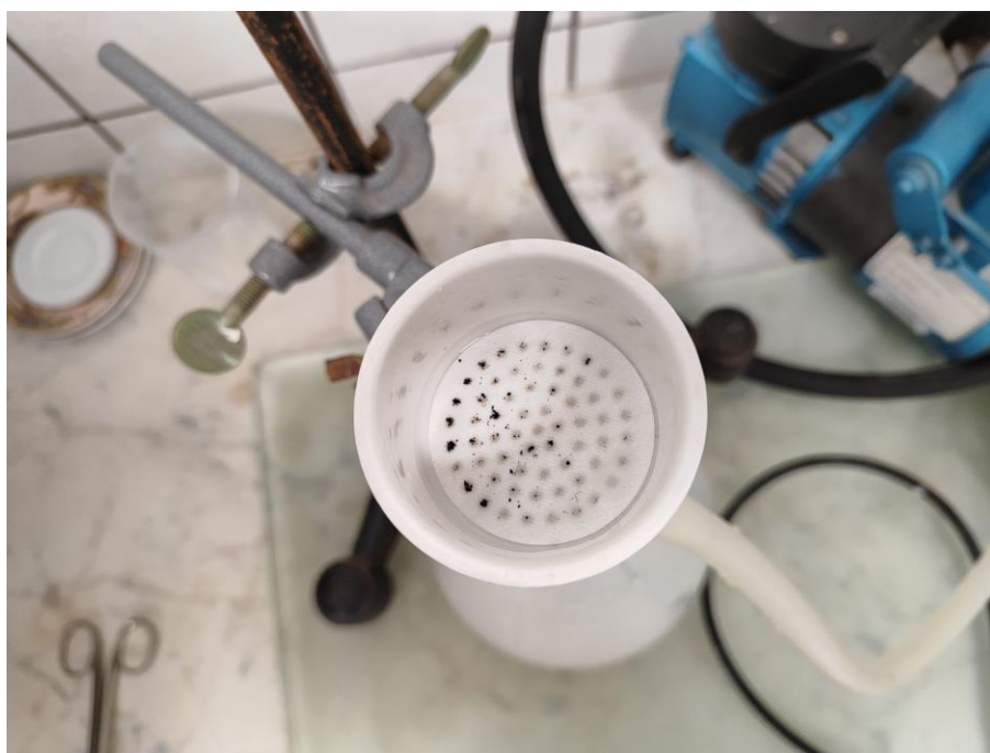
Slika 8 Iskorišteni filter papir nakon otapanja gornjeg sloja zaleđene tekućine. Slikano u laboratoriju Mineraloško-petrografskog zavoda PMF-a. Fotografija: Karl Bičanić.
