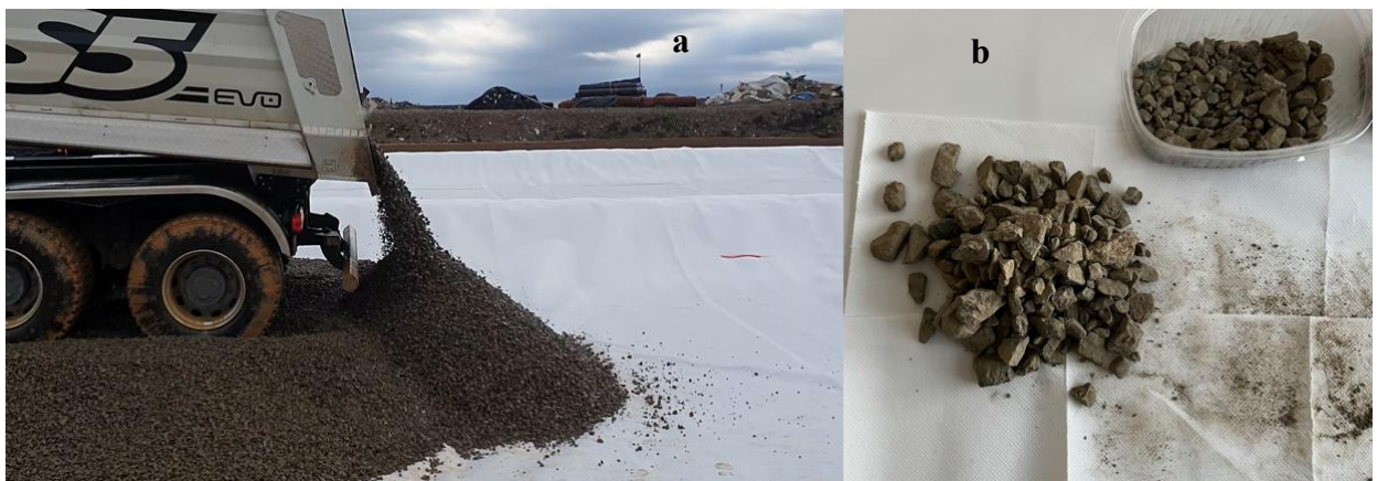
Slika 14. a : Uzorkovanje drenažnog materijala prilikom nasipavanja b : drenažni materijal prilikom granulometrijske analize (desno) (foto: Ivan Deotto)
