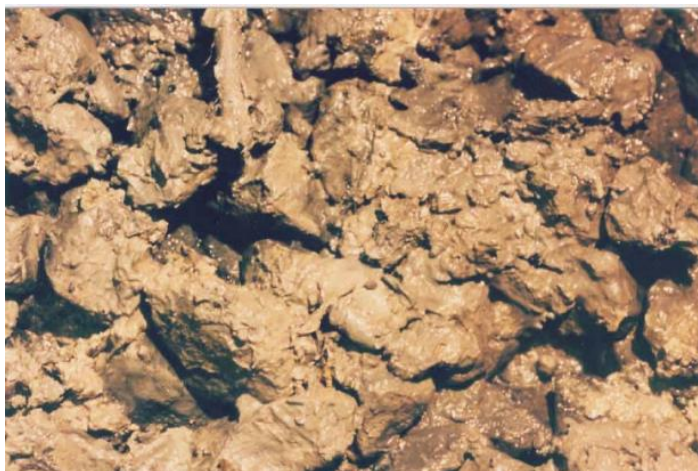
Slika 4 Drenažni šljunak (38 mm) nakon 20 mjeseci izlaganja procjednim vodama (FLEMING i ROWE 2004)
