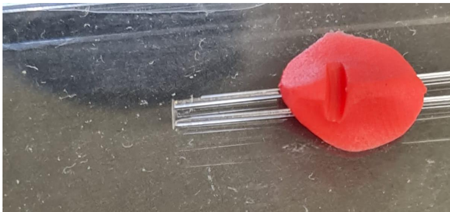
Slika 9: Dvije zavarene kapilare pričvršćene komadom plastelina na predmetno stakalce i mali listić lepidolita postavljen u položaj za izvođenje eksperimenta.
