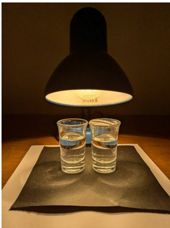
Slika 4. Postav za pokus "Efekt staklenika".
