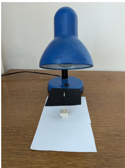
Slika 3. Postav za osvjetljivanje crnog papira.
