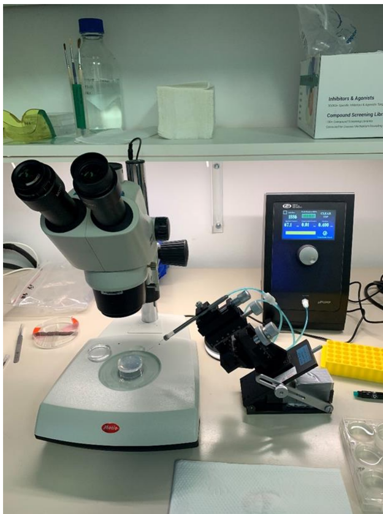
Slika 13. Aparatura za mikroinjektiranje (lupa, mikroinjektor, mikromanipulator) (foto M. Kuzman)
