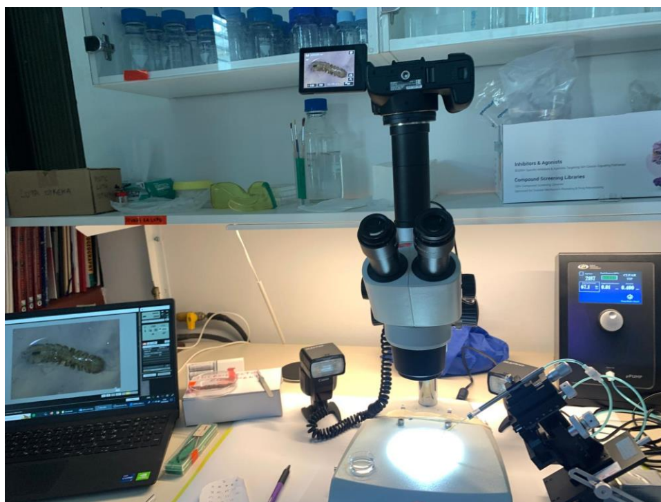
Slika 15. Aparatura za mikroinjektiranje (Lupa, mikroinjektor, prijenosno računalo, fotoaparat, bljeskalice) (foto M. Kuzman)
