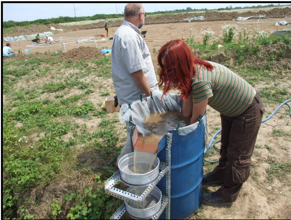
Slika 11. Primjer flotacijskog uređaja (Foto: Andreja Kudelić)
