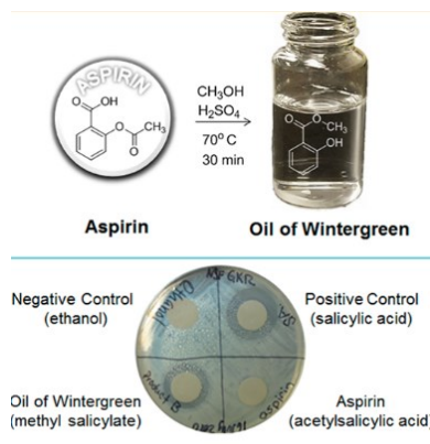
Slika 3.3. Prikaz pokusa sinteze ulja zimzelena (metil salicilata) iz aspirina te testiranja antibakterijskih svojstava pomoću testa inhibicije zone. 33
