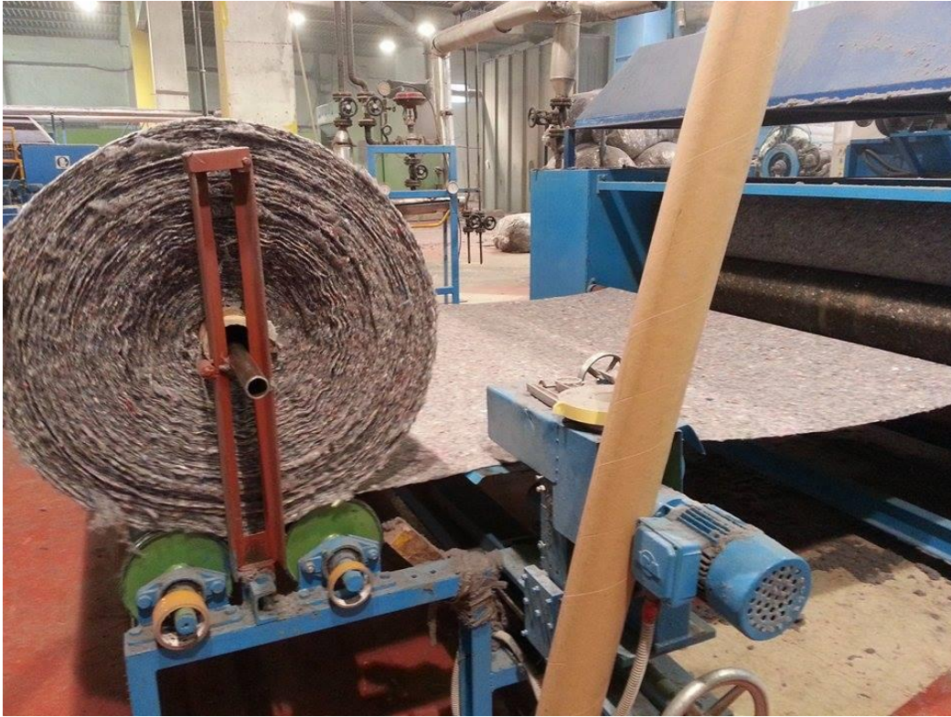
Slika 14. Površinska termička obrada iglanih filčeva i kalibriranje.
