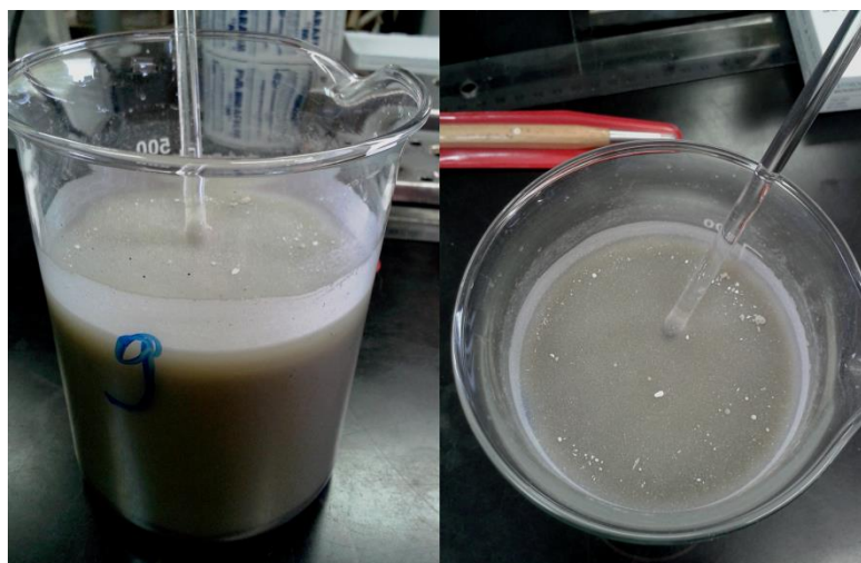
Slika 24. Nakupljanje bijelosive nepoznate materije na površini suspenzije uzorka ET-9.
