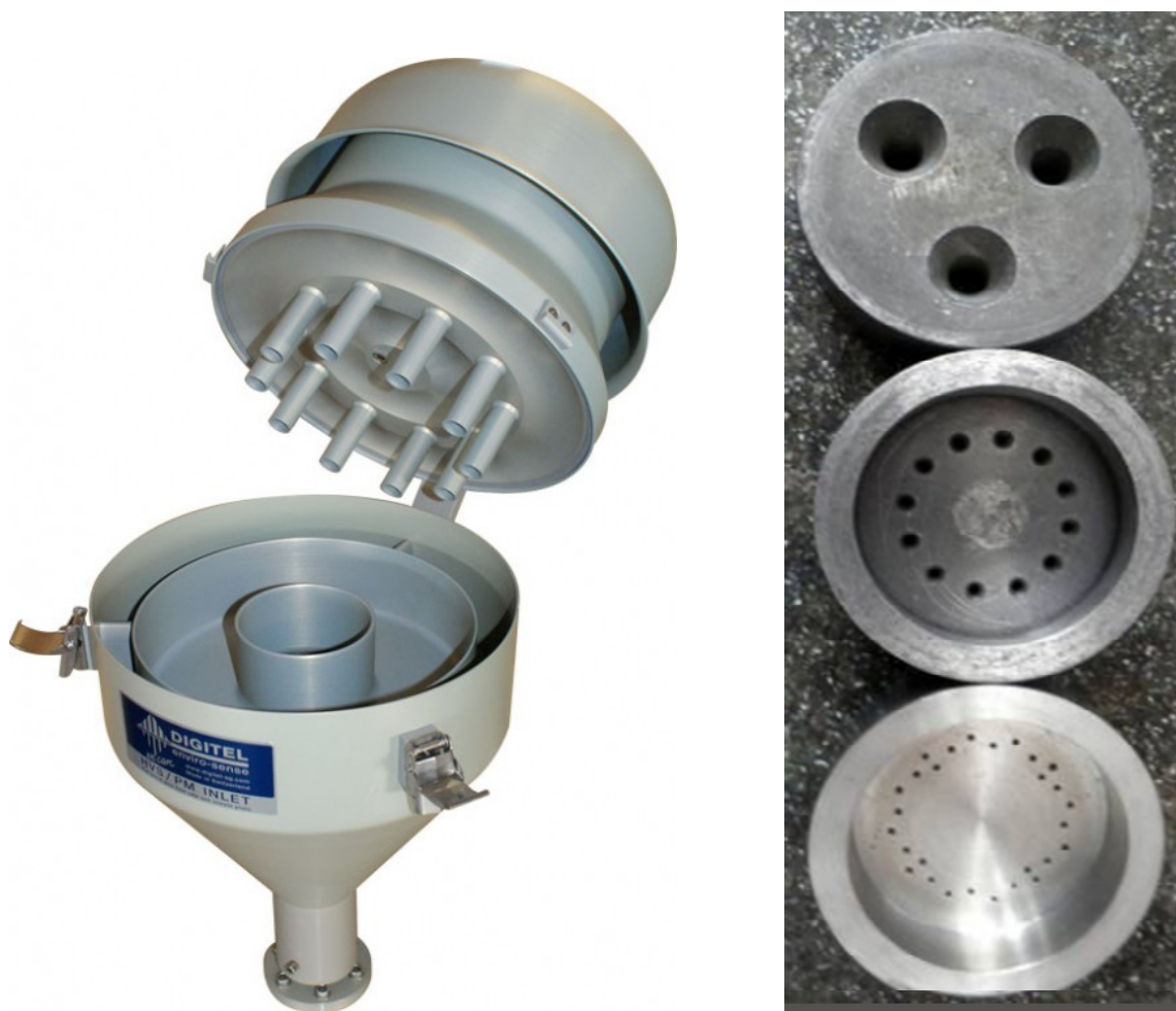
Slika 7. Impaktori za sakupljanje frakcija PM_{10} , PM_{2,5} i PM_1 [preuzeto s http://www.digitel-ag.com/de/wp-content/uploads/DPM_10_30_00-e1352211295177.jpg i Godec]
