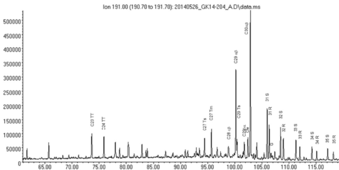
Slika 30 Rezultati GCMS analize: fragmentogram mase m/z 191 alkanske frakcije nafte A-1 s terpanskim fingerprintom (Fond stručne dokumentacije INA-e)
