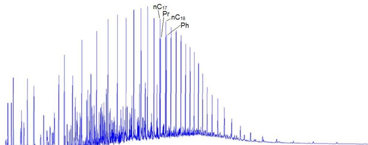
*Slika 27 Plinskokromatografski profil „whole oil“ nafte A-1 (ležište 2058-2061 m) (Fond stručne dokumentacije INA-e)*
