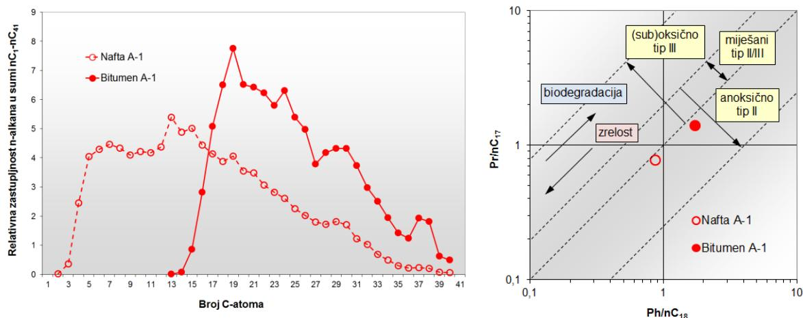
Slika 29 Plinskokromatografski (GC) rezultati; lijevo: raspodjela n-alkana u „whole oil“ nafti ( $C_1$ - $C_{40}$ ) i alkanskoj frakciji bitumena A-1; desno: odnosi izoprenoida prema n-alkanima koji ukazuju na podrijetlo i taložni okoliš izvorne biomase
