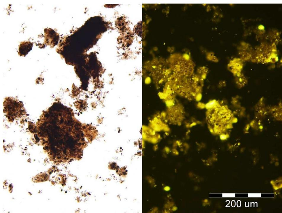
Slika 26 Izolirana organska tvar, liptodetrinit u amorfnoj organskoj tvari. Lijevo prolazno svjetlo, desno plavo fluorescentno svjetlo (Fond stručne dokumentacije INA-e)
