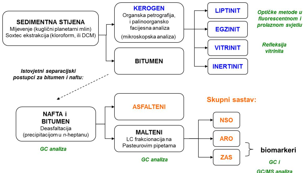
Slika 6 Shema postupaka s površinskim i bušotinskim uzorcima stijena, te s naftom i bitumenom u organskoj geokemiji
