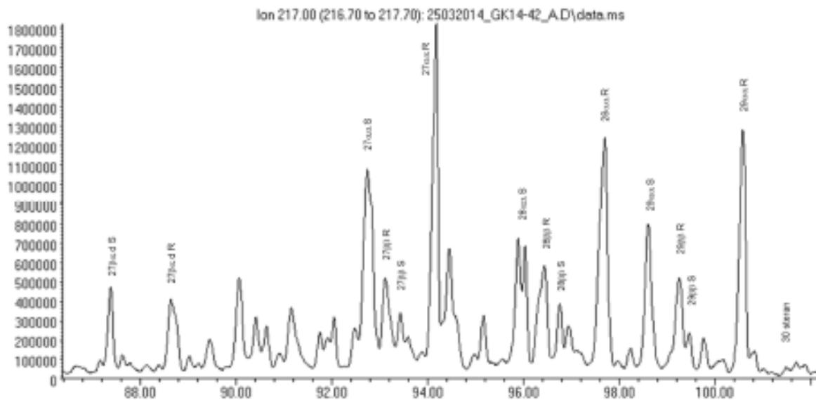
*Slika 33 Rezultati GCMS analize: fragmentogram mase m/z 217 alkanske frakcije bitumena A-1 sa steranskim fingerprintom
