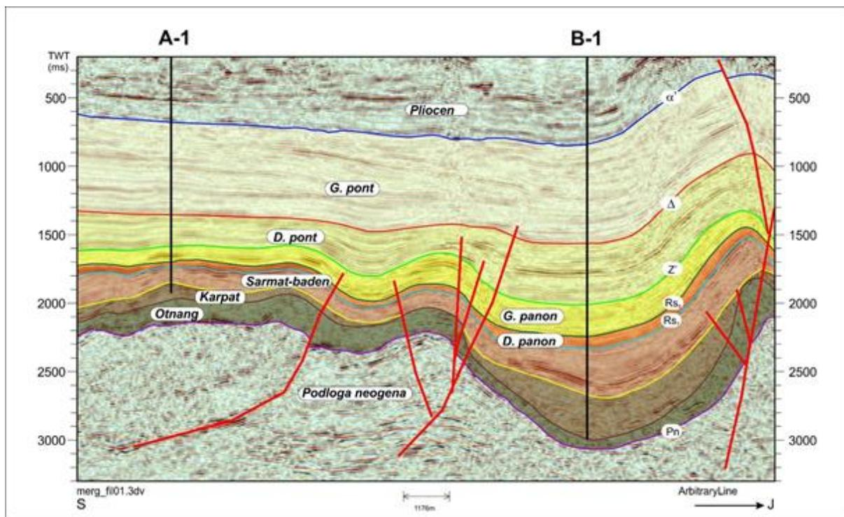
Slika 7 Interpretirani seizmički profil kroz bušotinu A-1 i prepostavljeni depocentar sa bušotinom B-1
