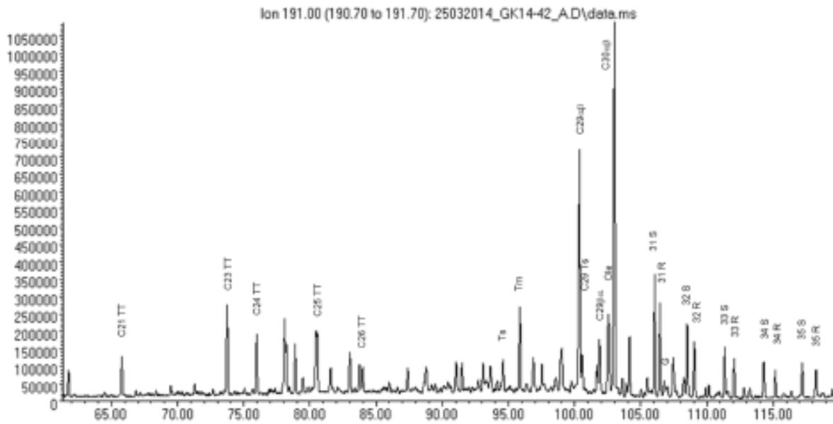
Slika 32 Rezultati GCMS analize: fragmentogram mase m/z 191 alkanske frakcije bitumena A-1 sa terpanskim fingerprintom (Fond stručne dokumentacije INA-e)
