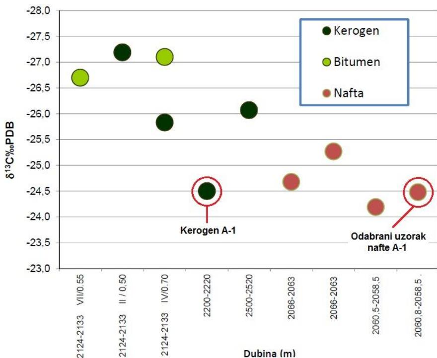
Slika 35 Odnos stabilnih izotopa  $\delta^{13}\text{C}$  za kerogene, bitmene i naftu u bušotini A-1 (Fond stručne dokumentacije INA-e)
