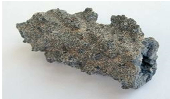
Slika 53: Okamenjene munje ili fulguriti; posljedica su toplinskog djelovanja udara munje u pjeskovito tlo. Nastaju zbog izgaranja ili topljenja sastojaka tla ( naročito ako sadrže čestice kvarca), koji se zatim brzo ohlade. [16]
