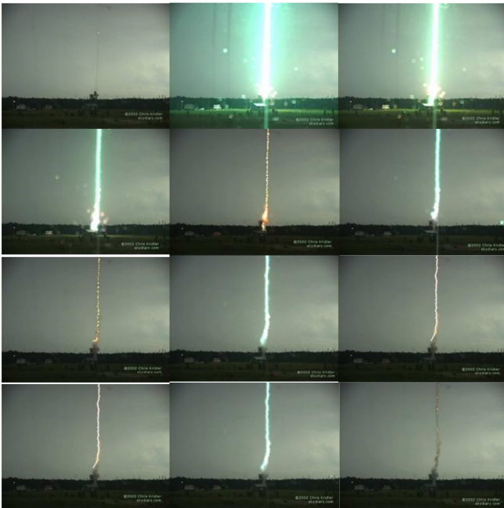
Slika 43: Slijed udara munje nakon lansiranja rakete. Prvi udar se formira prema tornju po vodljivom putu nastalom nakon isparavanja žice. Ostale slike pokazuju povratne udare. [27]
