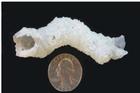
Slika 53: Okamenjene munje ili fulguriti; posljedica su toplinskog djelovanja udara munje u pjeskovito tlo. Nastaju zbog izgaranja ili topljenja sastojaka tla ( naročito ako sadrže čestice kvarca), koji se zatim brzo ohlade. [16]
