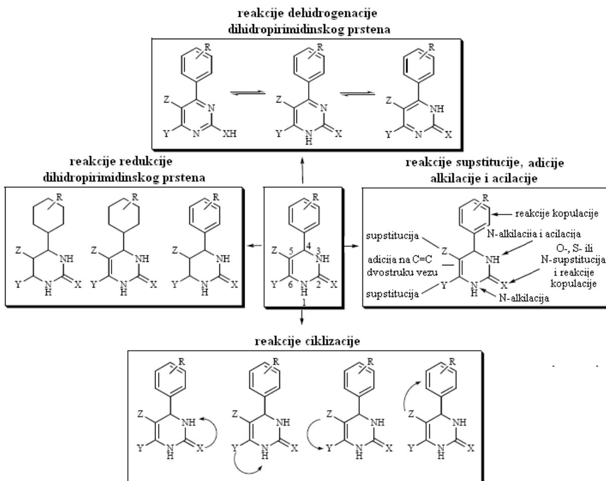
Slika 18. Reaktivnost Biginellijevih dihidropirimidinona.
