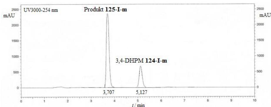
Slika 24. Kromatogram 3,4-dihidropirimidinona **124-I-m** i produkta **125-I-m**.
