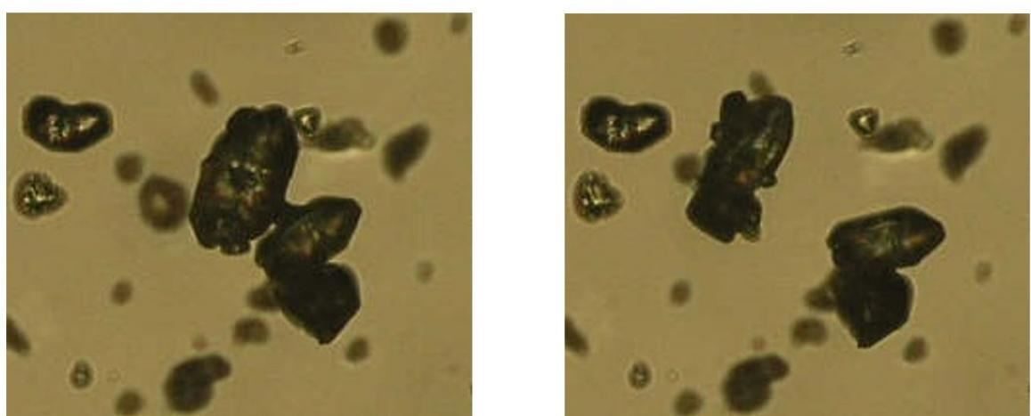
Slika 4.11: Kristali prije (lijevo) i poslije (desno) faznog prijelaza  $III \rightarrow II$  na temperaturi od  $88^{\circ}\text{C}$
