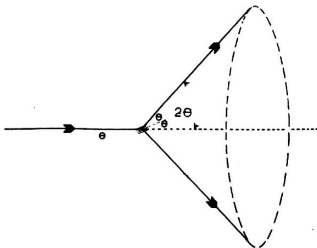
Slika 3.4: Shema konusa nastalog difrakcijom na polikristalnom uzorku
