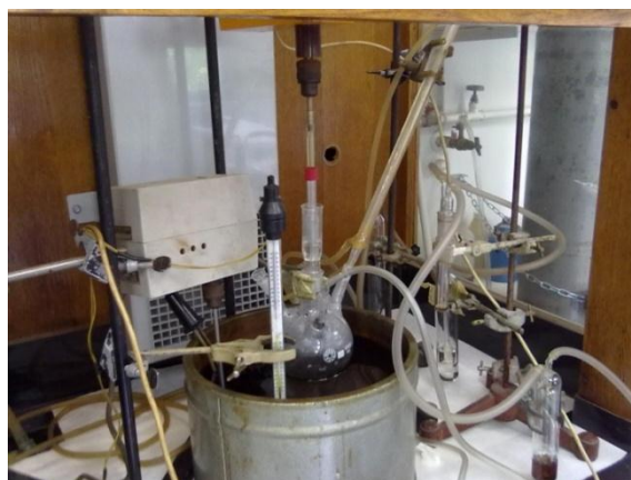
Slika 40 Priprema srebrnih nanočestica redukcijom s citratima u uljnoj kupelji.
