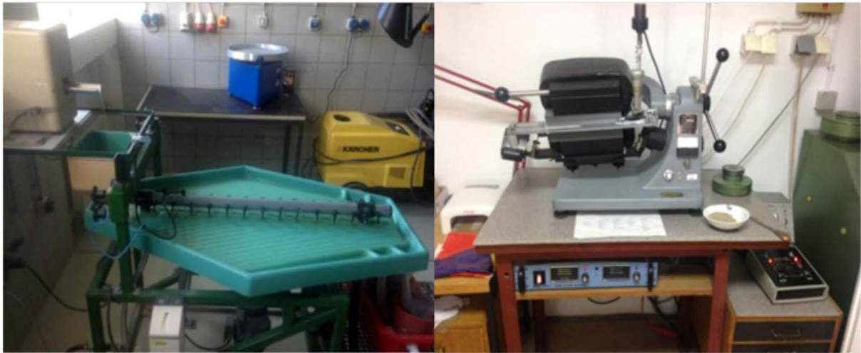
Slika 3.10. Lijevo: Wilfleyev stolić (iz Sveučilišta u Beču, Laboratorij za geokronologiju), desno: Frantzov izodinamski magnetni separator (Hrvatski geološki institut).
