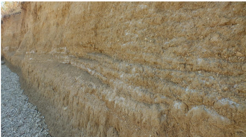
Slika 5.1.1. Izdanak na istraživanom području s jasno izraženom uslojenošću i vidljivom bijelom „koricom“ soli.
