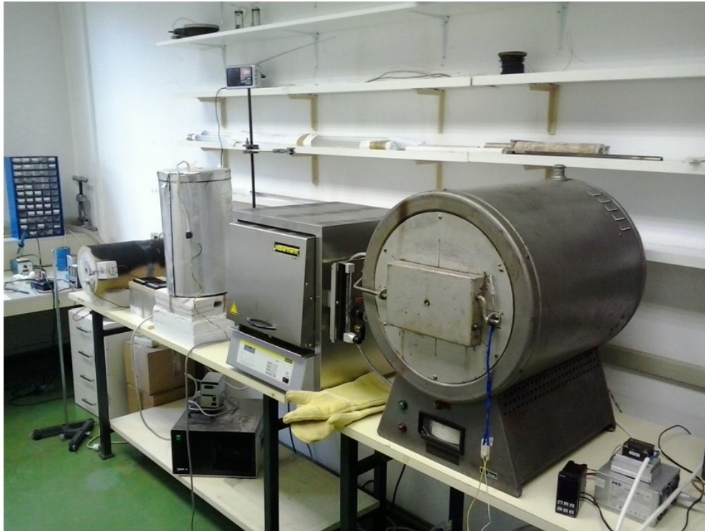
Slika 5.2: Peći u kojima se izvodila sinteza. U desnoj je materijal rastaljen i homogeniziran, dok se lijeva sa instaliranim bakrenim vodičem topline koristila za hlađenje (kristalizaciju).
