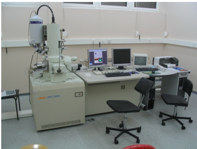
Slika 4.13: Skenirajući elektronski mikroskop JSM 7000F Zavoda za kemiju materijala, Instituta Ruđer Bošković.
