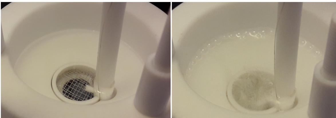
Slika 3.13: Mirna i burna evolucija vodika za vrijeme snimanja IV karakteristike.
