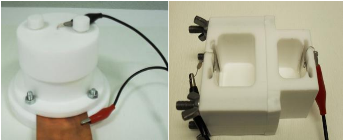
Slika 3.3: Dvije izvedbe komorice za elektrokemijsko jetkanje poroznog silicija. S jednim bazenom (lijevo) i s dva bazena (desno). Preuzeto iz [29].
