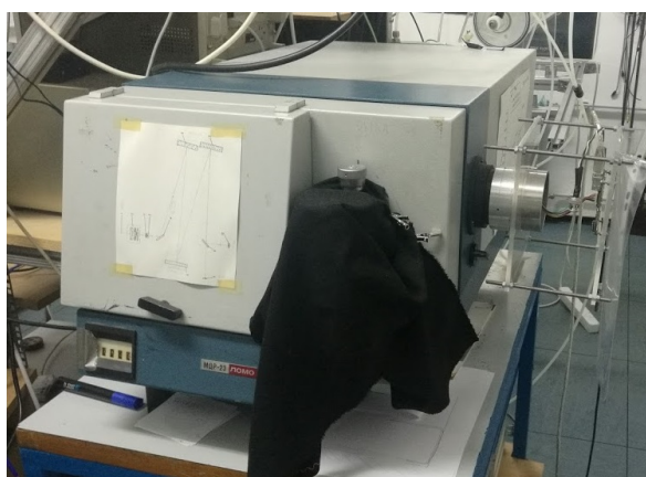
Slika 3.6: Slika monokromatora LOMO MDR 23
