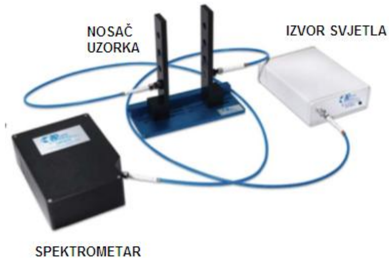
Slika 3.12 Eksperimentalni postav za mjerenje faktora transmisije. Naznačeni su osnovni dijelovi: spektrometar, nosač uzorka i izvor svjetla.
