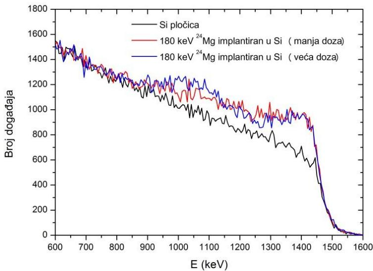
*Slika 4.16.* RBS spektri dobiveni pomoću snopa 4 MeV  ${}^7\text{Li}^{3+}$  iona na uzorcima Si implantiranih s dvije različite doze sa 180 keV-skim  ${}^{24}\text{Mg}$  ionima te na pločici kristaliničnog Si.
