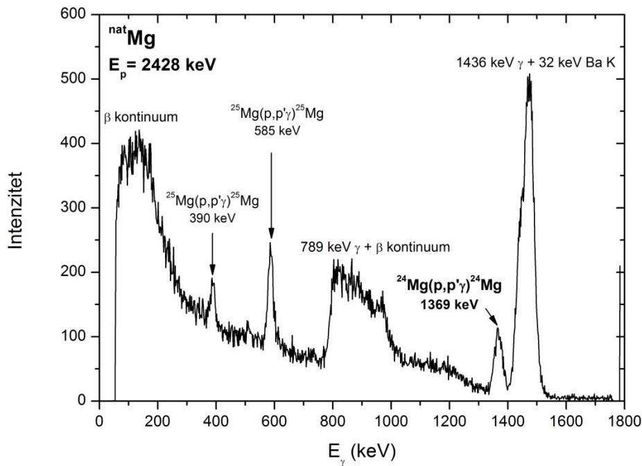
*Slika 5.5.* Gama-spektar snimljen na debeloj meti prirodnog Mg s LaBr<sub>3</sub>:Ce scintilacijskim detektorom i pobudom protonima energije 2428 keV-a.
