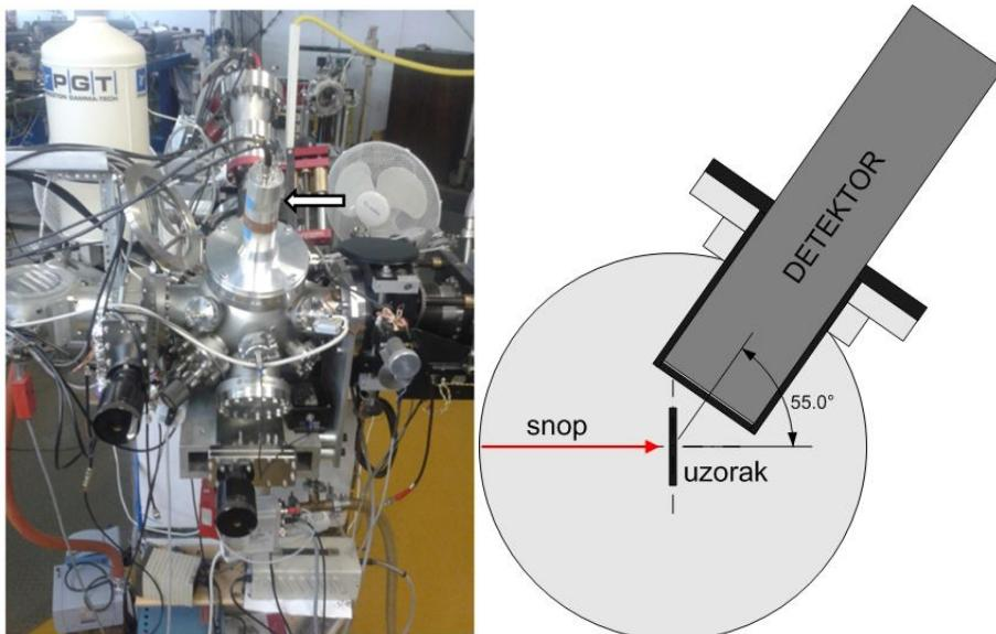
Slika 5.4. (a) Fotografija postava na mikroprobi sa  $\text{LaBr}_3:\text{Ce}$  scintilacijskim detektorem (označenim sa strelicom). (b) Shematski prikaz unutrašnjosti komore za dani postav. Udaljenost između uzorka i detektora je 3 cm.
