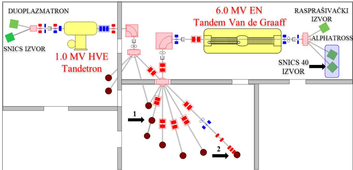
*Slika 3.1.* Shematski prikaz ubrzivačkog sustava Instituta Ruđer Bošković. S crnim strelicama označene su komore za raspršenje korištene u ovom radu: (1) PIXE/PIGE/RBS komora u kojoj su mjereni diferencijalni udarni presjeci i rađeno rezonantno dubinsko profiliranje; (2) ionska mikroproba.
