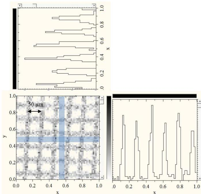
*Slika 5.2.*  $64 \times 64$  piksela dvodimenzionalna PIXE Cu mapa s projekcijama na x i y osi. Mapa se dobila skeniranjem snopa preko Cu mrežice s periodom ponavljanja od  $50 \mu\text{m}$ . Na temelju toga se odredila veličina vidnog polja od  $300 \times 300 \mu\text{m}^2$ .
