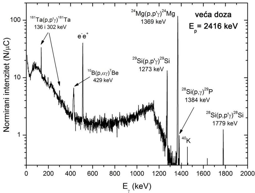
Slika 4.6. Gama-spektar Si uzorka implantiranog sa 180 keV-skim  $^{24}\text{Mg}$  ionima s većom dozom dobiven pobudom protonima energije 2416 keV-a i s naznačenim najintenzivnjim gama-linijama. Osim očekivanih linija od  $^{24}\text{Mg}$  i Si, vidi se i linija bora iz Si pločice (p-tip silicija dopiran je s manje od 0.1 % B atoma), te linije Ta koje dolaze od tantalovih kolimatora u eksperimentalnoj liniji.
