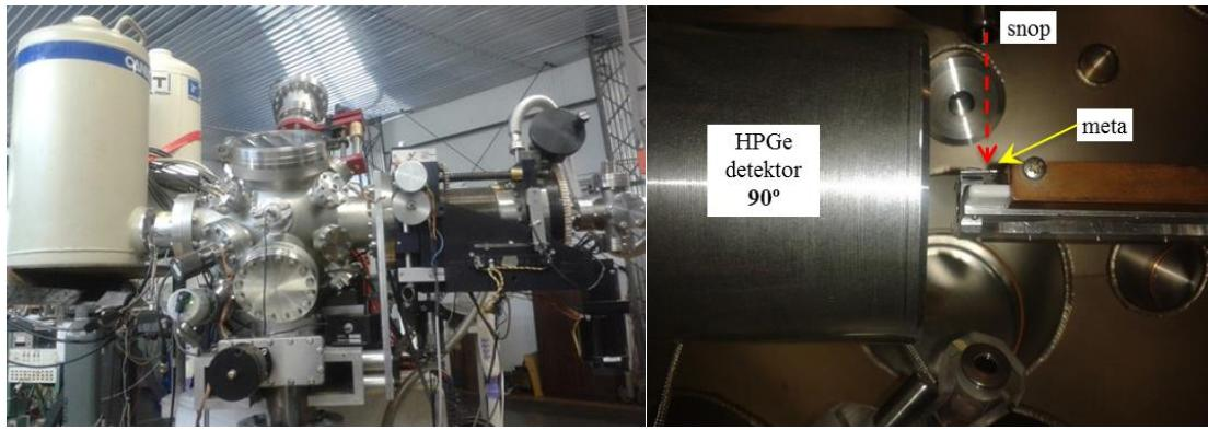
*Slika 5.8. (lijevo) Fotografija postava na mikroprobi s HPGe detektorom koji je postavljen na mjesto predkomore za stavljanje uzorka u mikroprobu. (desno) Shematski prikaz unutrašnjosti komore za dani postav. Udaljenost između uzorka i detektora je 1.5 cm.*
