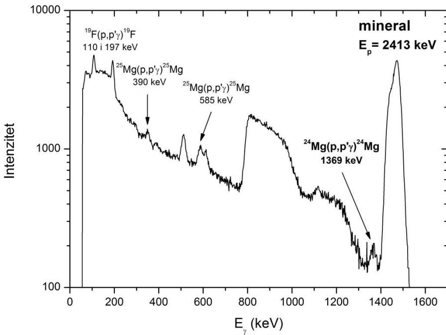
*Slika 5.7.* Gama-spektar minerala sastavljenog od talka ( $\text{Mg}_3\text{Si}_4\text{O}_{10}(\text{OH})_2$ ) i pirita ( $\text{FeS}_2$ ) snimljen s  $\text{LaBr}_3:\text{Ce}$  scintilacijskim detektorom i pobudom protonima energije 2413 keV-a.
