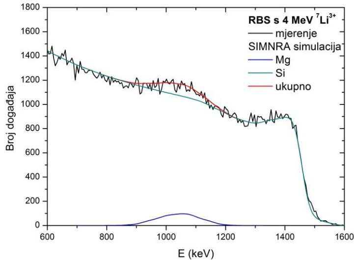
Slika 4.17. RBS spekar dobiven pomoću snopa 4 MeV-skih  $^7\text{Li}^{3+}$  iona na uzorku Si implantiranog sa 180 keV-skim  $^{24}\text{Mg}$  ionima (velika doza).
