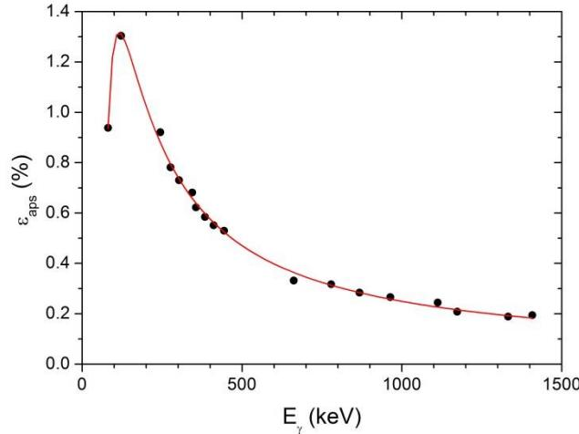
Slika 3.6. Izmjerena absolutna efikasnost HPGe detektora kao funkcija energije gama-zračenja za korištenu geometriju mjerenja prikazanu na Slici 3.4. Crvena linija je funkcija prilagodbe, tzv. krivulja efikasnosti. Može se uočiti da absolutna efikasnost jako brzo opada s energijom gama-zračenja.
