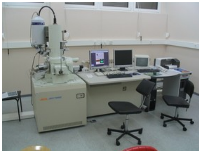
Slika 50. Skenirajući elektronski mikroskop Jeol JSM-7000F, Institut Ruđer Bošković, Zavod za kemiju materijala.
