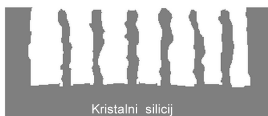
Slika 15. Shematski prikaz poroznog silicija na podlozi kristalnog silicija.
