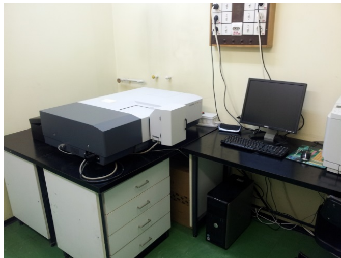
Slika 49. Shimadzu UV/VIS/NIR spektrometar model UV-3600, Institut Ruđer Bošković, Zavod za kemiju materijala.
