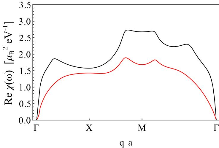
**Slika 3.24:** Susceptibilnost  $\chi^{(0)}$  s konstantnim malim gušenjem, na 50 K (crno) te s  $\mathbf{k}$ -ovisnim gušenjem (crveno) s maksimumom na vH točki. Doprinos od dijelova Fermijeve plohe uz rub BZ je znatno potisnut, čime nestaju i maksimumi na malim valnim vektorima, karakteristični za pojavu vala gustoće naboja.
