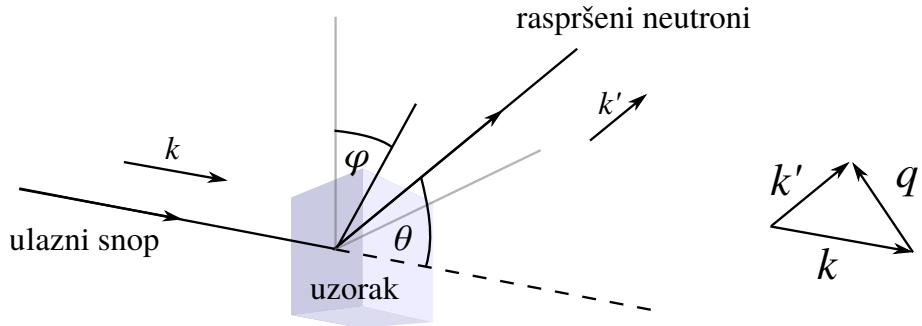
**Slika 2.7:** Geometrija eksperimentalnog postava za mjerjenje spektra raspršenja neutrona.
