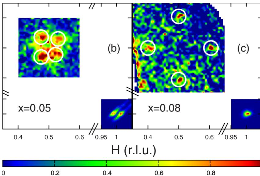
**Slika 2.10:** Nekomenzurabilni signali u neutronskom raspršenju u LBCO-u [23]. Lijevo: dijagonalni na niskim dopiranjima, izvan supravodljivog područja. Desno: statički kolinearni signali magnetskog uređenja koegzistiraju sa supravodljivošću.
