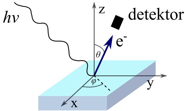
**Slika 2.1:** Geometrija  $\mathbf{k}$ -ovisne fotoemisije, odnosno ARPES eksperimenta. Energije i valni vektori ulazećeg fotona i izlazećeg elektrona su dovoljne za određivanje stanja elektrona prije procesa emisije.
