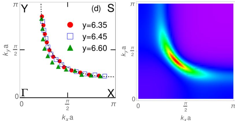
**Slika 4.5:** Prilagodbe modela s jednom vrpcom i preskocima na druge i treće susjede (parametri u tablici 4.3). Lijevo: gola Fermijeva ploha, desno: intenzitet na Fermijevom nivou sličan eksperimentalnom je dobiven korištenjem  $\mathbf{k}$ -ovisnog gušenja koje je pojačano na rubu IBZ.
