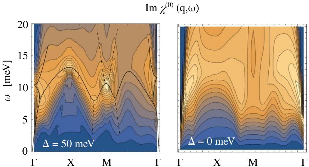
**Slika 3.30:** Imaginarni dio neinteragirajuće elementarne susceptibilnosti  $\chi^{(0)}(\mathbf{q}, \omega)$  s procjepom (lijevo) i bez njega (desno). Bez procjepa nema nikakvih pojava u susceptibilnosti: spinskog procjepa, "rezonancija" i slično. Linije na lijevoj slici su vodilje za oko duž lokalnih maksimuma koji podsjećaju na akustičke unutarvrpcane i "optičke" međuvrpcane čestično-šupljinske procese.
