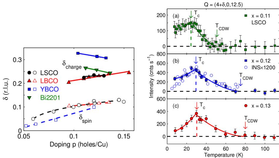
**Slika 2.14:** CDW fluktacije prate ovisnost SDW fluktacija u lantanovim kupratima: oba nekomenzurabilna vektora rastu s porastom dopiranja. Na desnoj slici se jasno opaža slabljenje CDW signala ispod  $T_C$  što znači da su ta dva uređenja termodinamički superotstavljeni. U jednoravninskom BSCCO-u CDW valni vektor se smanjuje dopiranjem.
