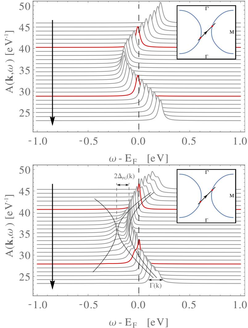
**Slika 2.5:** EDC prikaz spektralne funkcije za LSCO parametrizaciju bez raspršenja (gore) te s raspršenjem na magnonima (dolje). Sa slike možemo iščitati iznos pseudoprocjepa  $\Delta(\mathbf{k})$  i širine spektralnih linija  $\Gamma(\mathbf{k})$ .
