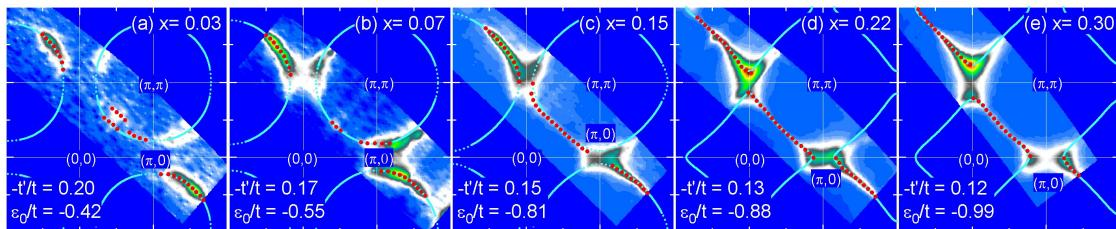
**Slika 4.1:** ARPES presjeci na Fermijevoj energiji za LSCO uzorke u širokom rasponu dopiranja [40]. Važno je primjetiti da se čak i u AF uzorcima s dopiranjem oko 1% primjećuje komad Fermijeve plohe. Duljina Fermijevog luka raste sa šupljinskim dopiranjem te oko vH dopiranja on seže u potpunosti do vH točke.
