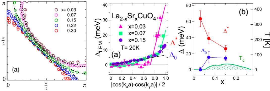
**Slika 4.2:** Lijevo: Prilagodba ARPES maksimuma intenziteta na Fermijevoj energiji na model s tri vrpce. Na niskim dopiranjima prilagodbu vršimo samo na središnji dio Fermijeve plohe, budući da su njeni dijelovi na rubu BZ jako zamućeni i unutar procjepa. Točke predstavljaju maksimume MDC-ova iz [40], a parametri prilagodbe su dani u tablici 4.1. Sredina i desno: PG i SC procjepi u LSCO-u, prema [41].
