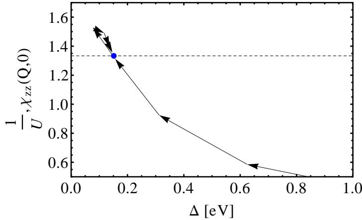
**Slika B.1:** Samosuglasno rješavanje jednadžbe za procjep  $\Delta$ . Ljeva strana jednadžbe je konstanta  $\frac{1}{U}$ , označena crtkom horizontalnom linijom. Desna strana je monotono padajuća funkcija procjepa, a smjer iteracija je označen strelicama. Korišteni su parametri za LSCO te  $U = 0.75$  eV, a dopiranje je u svakoj iteraciji samosuglasno održano na 10%. Točna vrijednost označena je plavim krugom i iznosi  $\Delta = 0.151$  eV.
