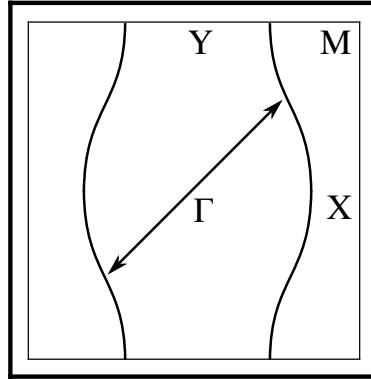
**Slika 3.3:** Ugnježđenje kvazi-1D vrpce. Sva ili približno sva stanja na Fermijevoj energiji se mogu raspršiti s odgovarajućim parom udaljenim za isti valni vektor.
