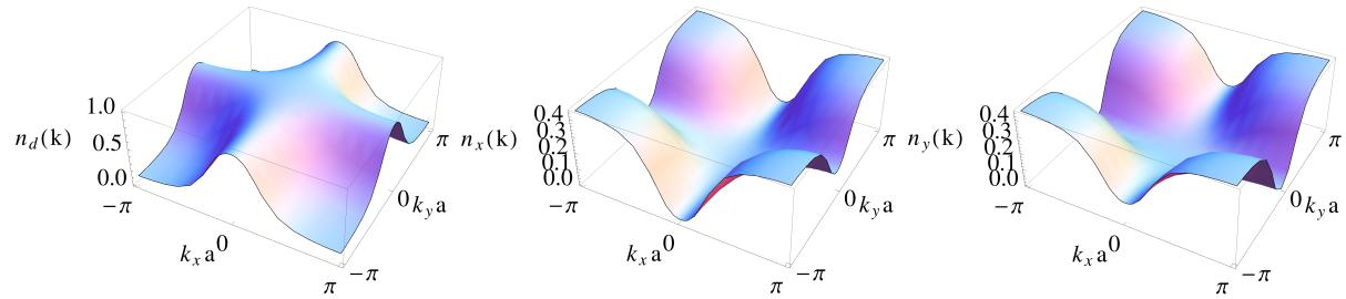
**Slika 3.7:** Iznosi svojstvenih vektora, tj. projekcija vezujuće vrpce na orbitale bakra, kisika na x-osi te kisika na y-osi 2D rešetke. Korišteni su parametri  $t_{pd} = 0.15$  eV,  $t_{pp} = 0.45$  eV i  $\Delta_{pd} = 0.75$  eV.
