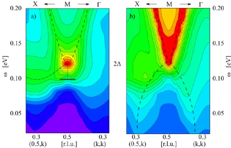
**Slika 3.33:** Učinak korelacija na niskotemperaturni magnetski spektar sa procjeppom  $\Delta > 0$ . Maksimum na  $\mathbf{Q}_{AF}$  i  $\omega = 2\Delta$  te grana pobuđenja na frekvencijama iznad  $2\Delta$  su vidljivi, ali se podigao intenzitet niskofrekvenske nekomenzurabilne grane "pješčanog sata".
