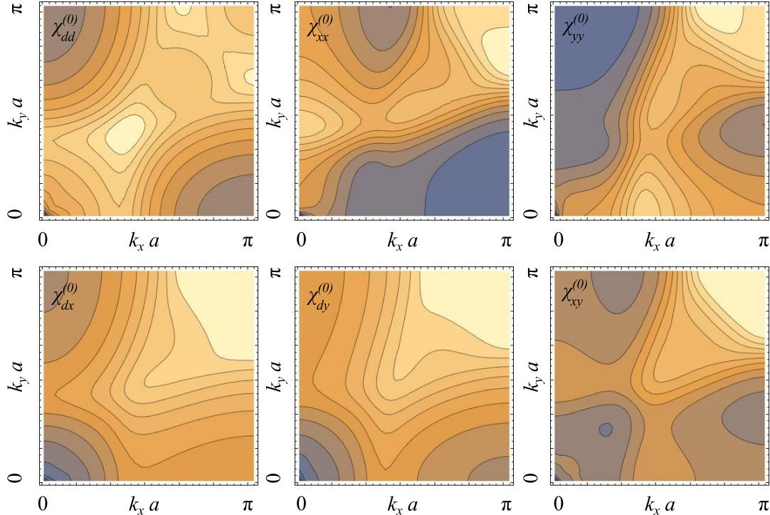
**Slika 3.14:** Komponente susceptibilnosti pojedinih stupnjeva slobode u Emeryjevom modelu (svjetlijije boje znače veću vrijednost). U gornjem redu:  $\chi_{dd}^{(0)}$  s nekomenzurabilnim vrhovima kao globalnim maksimumima te  $\chi_{xx/yy}^{(0)}$  koje su međusobno zrcalne oko dijagonale IBZ. U donjem redu:  $\chi_{xd}^{(0)}$ ,  $\chi_{yd}^{(0)}$  i  $\chi_{xy}^{(0)}$ .
