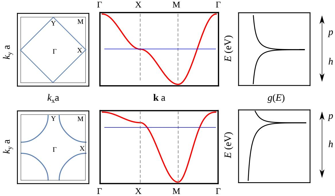
**Slika 3.1:** Fermijeva ploha (lijevo), vrpca duž linija visoke simetrije u IBZ (sredina) te gustoća stanja (desno) za model s jednom orbitalom po jediničnoj ćeliji. U gornjem redu prikazane su slike za  $t' = 0$ , a u donjem za konačnu vrijednost preskoka na druge susjede  $t' = -0.35t$ .
