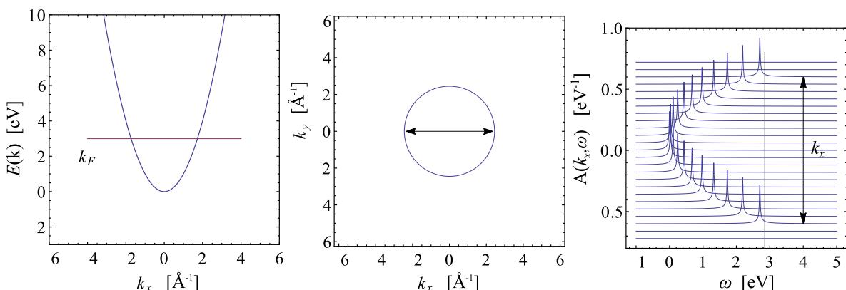
**Slika 2.2:** Disperzijska relacija slobodnog elektronskog plina: a) presjek u energiji i jednoj komponenti valnog vektora; b) 2D presjek na konstantnoj energiji; c) zamišljeni ARPES spektar idealnog sustava bez ikakvih raspršenja. Svakom stanju  $E(\mathbf{k})$  odgovara po jedan beskonačno uzak vrh u spektralnoj funkciji.
