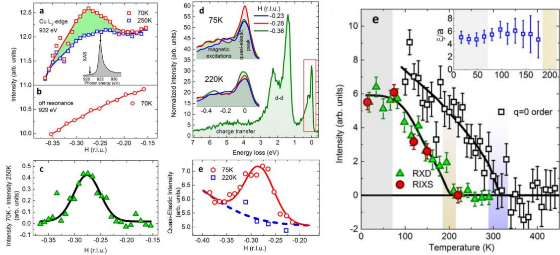
**Slika 2.13:** Rezultati eksperimenata raspršenja rendgenskih zraka na uzorku Hg1201 iz [27]. Lijevo: pojava signala na oko 0.28 j.r.r.; desno: temperaturna ovisnost CDW signala te  $q = 0$  signala pridruženog pseudoprocjepu.
