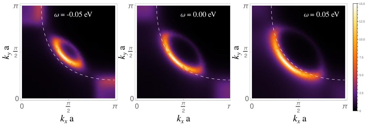
**Slika 2.3:** Intenzitet kakav bi izmjerio ARPES na  $E_F$  ( $\omega = 0$ ) te malo ispod i iznad  $E_F$  u sustavu s otvorenim procjepom te povećanim gušenjem oko vH točaka. Primjećuje se smanjeni intenzitet oko  $\mathbf{k}_{vh}$  te potpuno iščezavanje stanja s Fermijeve energije u tzv. "hotspotu". Stanja ispod i iznad Fermijeve energije otkrivaju disperzijske relacije vrpcu. Prazna stanja malo iznad  $E_F$  danas se mogu opažati i običnim, jednofotonskim ARPES uređajem uz pažljivu analizu.
