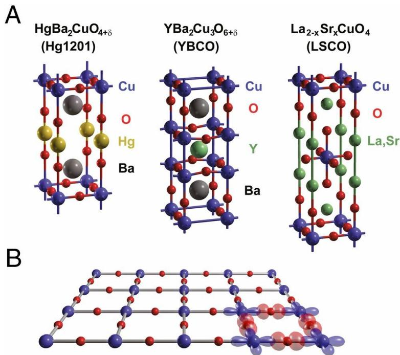
**Slika 1.3:** Struktura tri najznačajnija materijala te skica jedne ravnine bakrovog oksida. Vršni kisikovi atomi (na slici izvan  $\text{Cu}$ -ravnina) te primjese  $\text{Hg}$ ,  $\text{La}$ ,  $\text{Ba}$  premoštavaju  $\text{CuO}_2$  ravnine stvarajući među njima vrlo slabe veze. Vizualizacija je preuzeta iz [7].
