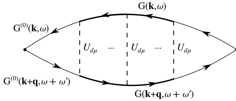
**Slika F.2:** Dijagram višeg reda u efektivnom međudjelovanju  $U_{d\mu}$ . Unutarnji propagatori, između 2 verteksa imaju efektivne spektralne težine  $z_k$ , a vanjski projektore na orbitale  $l, l'$  s vanjske strane dijagrama, a  $T_{d\pm}(k)$  s unutranje.
