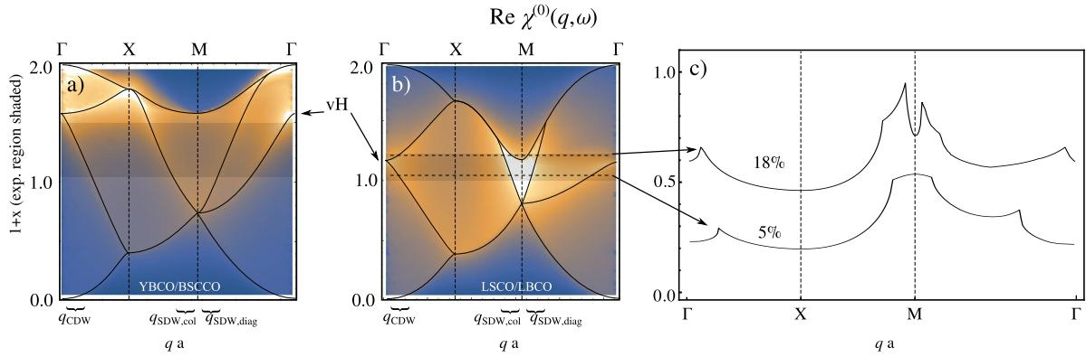
**Slika 3.9:** Susceptibilnost  $\chi^{(0)}$  za dvije ekstremne parametrizacije u modelu 3 vrpce: lijevo veliki  $t_{pp}$ , bliže YBCO-u; u sredini mali  $t_{pp}$ , bliže LSCO-u. Crne linije koje označavaju lokalne maksimume i lomove u susceptibilnosti su vodilje za oči, određene numerički. Desno: susceptibilnost za jako podopiranu i predopiranu vrpcu.
