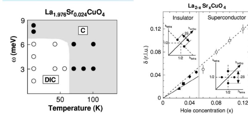
**Slika 2.9:** Valni vektori magnetskog nekomenzurabilnog uređenja u LSCO-u, preuzeti iz [22]. Lijevo: fazni dijagram pojave diagonalno nekomenzurabilnog signala u neutonskom rasprešenju za uorak izrazito niskog dopiranja - na visokim frekvencijama i temperaturama signal je komenzurabilan. Desno: ovisnost iznosa i orientacije nekomenzurabilnog valnog vektora o dopiranju.
