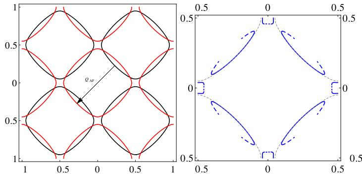
**Slika 3.17:** Za  $\mathbf{Q} = \mathbf{Q}_{AF}$  (lijevo) rezultat je Fermijeva ploha dobre simetrije i ispravne zakrivljenosti (desno). Također, ovaj model omogućuje postojanje dvije različite Fermijeve plohe usporedivog iznosa na kakve upućuju eksperimenti kvantnih oscilacija. Korišteni su isti parametri za LSCO kao i na slici 3.16.
