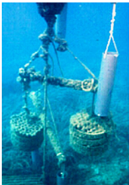
Slika 12. Stupice za sediment u pridnenom sloju vodenog stupca
