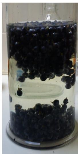
Slika 3.3. Postupak flotacije bobica grožđa
