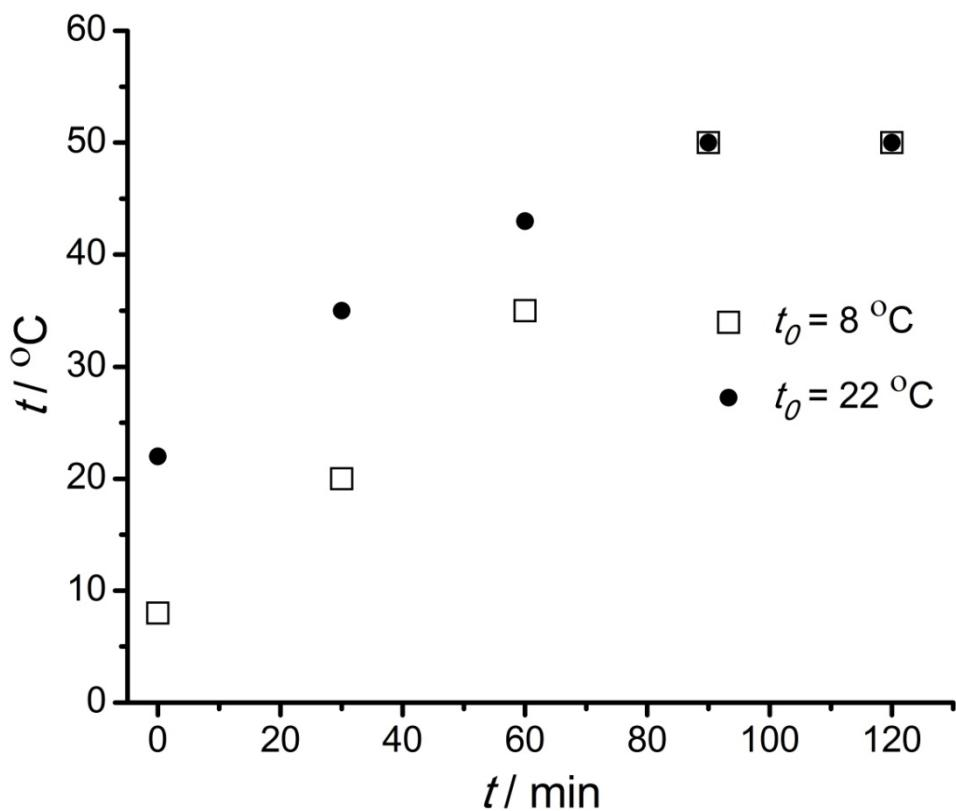
Slika 7.2. Određivanje ravnotežne temperature u ultrazvučnoj kupelji
