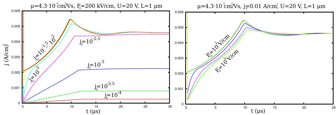
Slika 5.4: DITS tranzijenti u uređaju s neomskom, Richardson-Schotkyevom injekcijom, rezultati MOLED simulacija. Lijeva i desna slika pokazuju utjecaj varijacije parametara  $j_0$  i  $F_0$  u Richardson-Schotkyevoj formuli,  $j_{inj} = j_0 \exp(\sqrt{F/F_0})$ .
