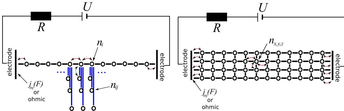
Slika 2.6: Shema uređaja - tankoslojnog filma s elektrodama spojenim na bateriju napona  $U$  - kakvog ga vidi MOLED (lijevo) i trodimenzionalna simulacija (desno).
