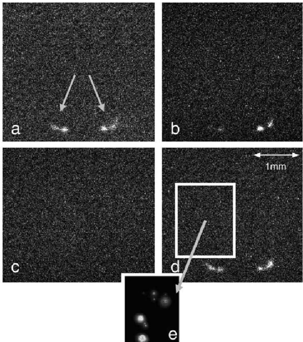
Slika 4.9: Infracrvene snimke polispiroflorenskega filma na katerem je aluminijska elektroda. [162] Na snimkama se uspešno menjajo napeti (a→d). Na sliki (c) uređaj je izključen. Pri ponovnem paljenju, na sliki (d), 'vruće točke' se pojavljajo na istim mestima. Detajl (e) pokazuje pojavu več filamenata pri večjem napetu (3 V).
