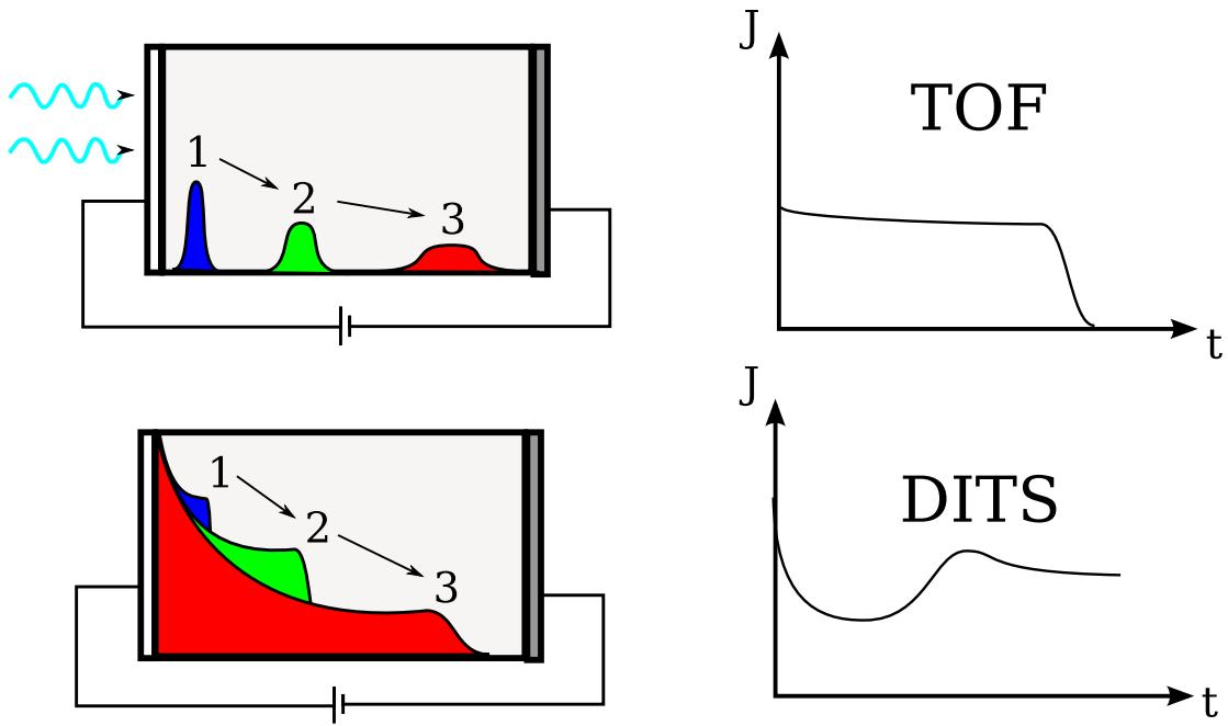
Slika 1.8: Shema mjerjenja mobilnosti TOF metodom (gore) i DITS metodom (dolje). Lijevo je prikazana evolucija dubinskog profila koncentracije nosioca (šupljina), u tri sukcesivna vremena, 1, 2 i 3. Desno je prikazana tranzijentna struja u vanjskom krugu, u slučaju kada je transport nedisperzivan.
