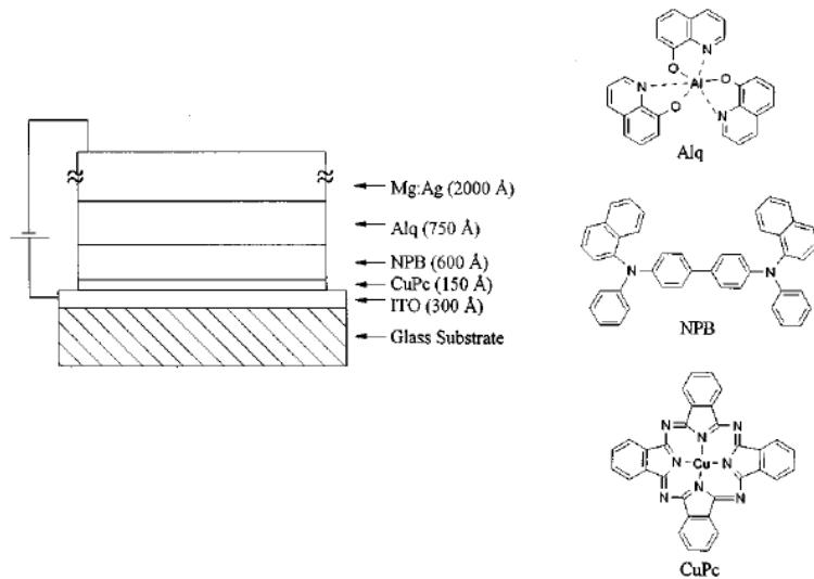
Slika 1.6: Shema svjetleće diode koju su konstruirali van Slyke, Chen i Tang, i strukturne forumule organskih sastojaka. Preuzeto iz [24].
