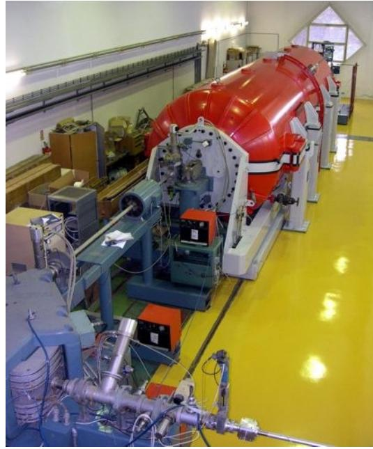
*Slika 31.* 6 MV EN Tandem Van de Graaff ubrzivač na Institutu ruđer Bošković. Na slici dolje lijevo vidi se dipolni skretni magnet (analizator) koji skreće ionski snop za  $90^0$  te se koristi za selekciju nabojnog stanja ionskog snopa.
