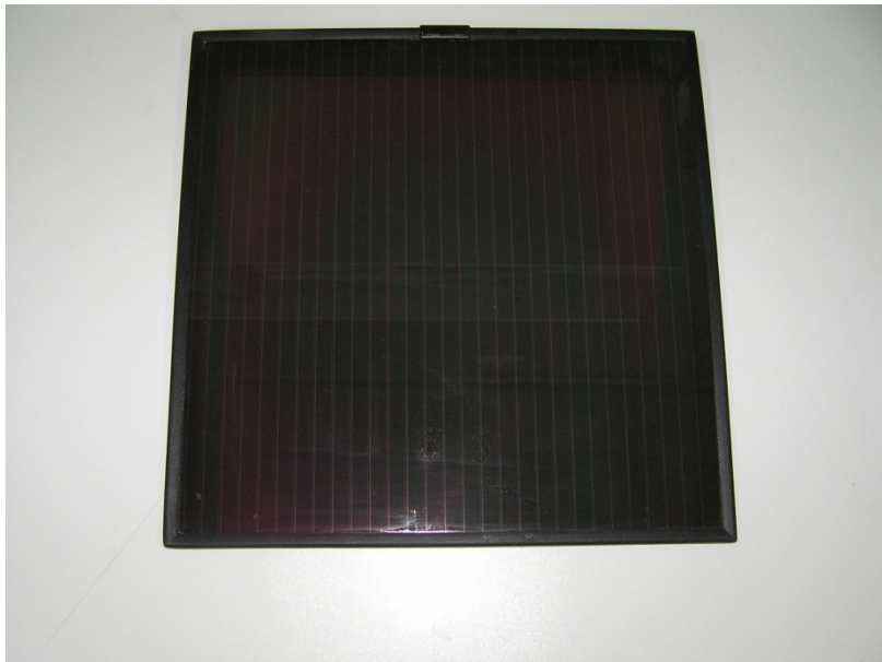
Slika 37 Izgled fotonaponskog modula korištenog pri mjerenju spektralnog odziva sunčeve ćelije. Modul je sastavljen od 29 serijski spojenih a-nc-Si:H sunčevih ćelija.
