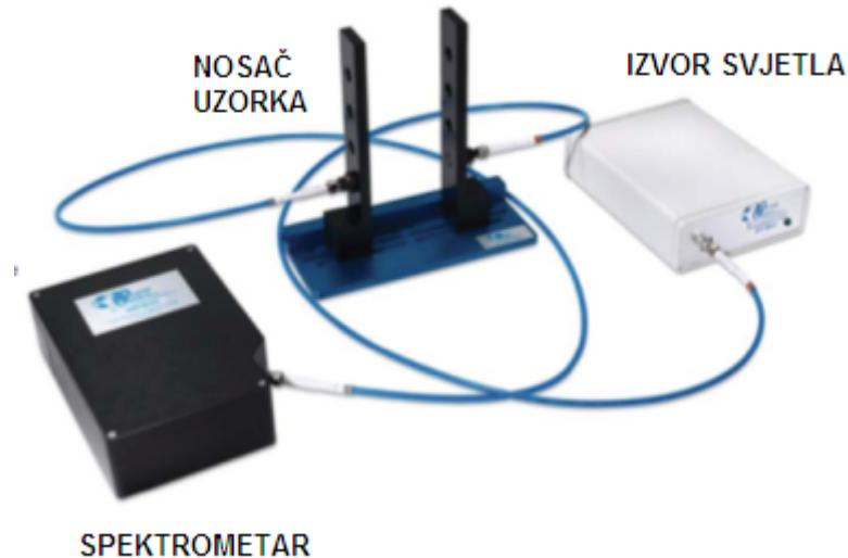
*Slika 28 Eksperimentalni postav za mjerjenje faktora transmisije. Naznačeni su osnovni dijelovi: spektrometar, nosač uzorka i izvor svjetla.*
