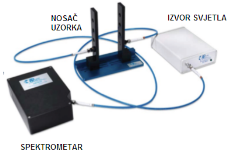
Slika 28 Eksperimentalni postav za mjerenje faktora transmisije. Naznačeni su osnovni dijelovi: spektrometar, nosač uzorka i izvor svjetla.
