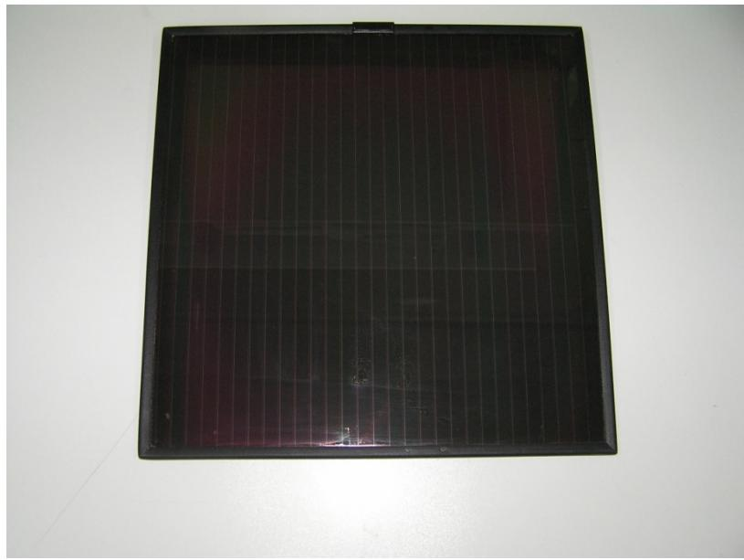
*Slika 37 Izgled fotonaponskog modula korištenog pri mjerenu spektralnog odziva sunčeve celije. Modul je sastavljen od 29 serijski spojenih a-nc-Si:H sunčevih celija.*
