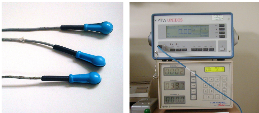
Slika 4-2. a) Diode, Scanditronix EDE-5. b) Elektrometri: Unidose (PTW) za ionizacijsku komoru, gore i DPD3 (Scanditronix) za diode, dolje.
