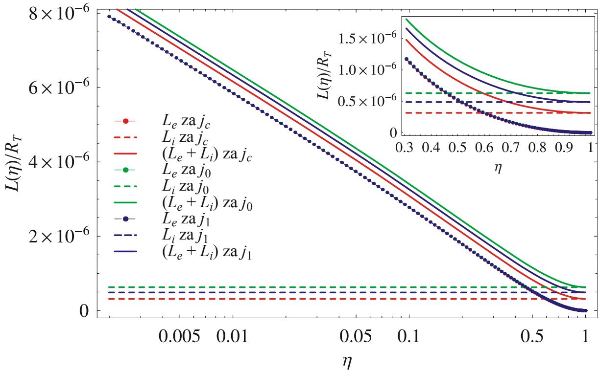
**Slika 4.20.:** Vanjski ( $L_e$ ), unutarnji ( $L_i$ ) i ukupni ( $L_i + L_e$ ) induktivitet za tri profila gustoće struje  $j_c$ ,  $j_0$  i  $j_1$ . Manja slika je u linearnoj skali i bolje prikazuje ovisnosti za velike vrijednosti  $\eta$ .
