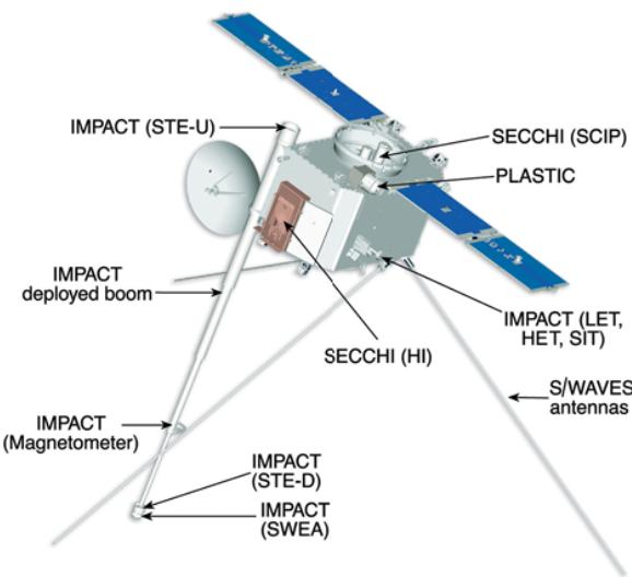
**Slika 3.11.:** Prikaz raspodjele instrumenata na STEREO-B satelitu. SECCHI (HI) instrument uvijek je usmjeren prema Suncu, dok su IMPACT i S/WAVES antene okrenute od Sunca. Postoje male razlike između raspodjela instrumenata na A i B satelitu iz razloga što suprotno okrenuti jedan prema drugom, a instrumenti koji mjere zastupljenost čestica moraju biti usmjereni duž magnetskog polja Sunčevog vjetra (Kaiser et al., 2008).
