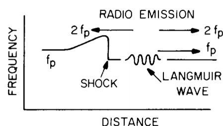
**Slika 3.19.:** Ilustracija nastanka radiovalnog zračenja udarnim valom u međuplanetarnom prostoru. Snop elektrona ubrzan udarnim valom pobuđuje plazmennu frekvenciju,  $f_p$  i frekvenciju harmonika,  $2f_p$ , u okolnoj plazmi (Gurnett i Kurth, 1996).
