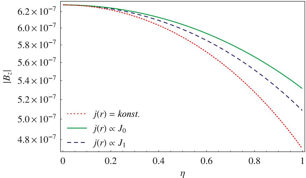
**Slika 4.17.:** Magnetsko polje u središtu  $O$  torusa: jakost komponente  $|B_z|$  je prikazana kao funkcija omjera polumjera  $\eta = r_T/R_T$  i to za tri prije definirane gustoće struje  $j(r)$ .
