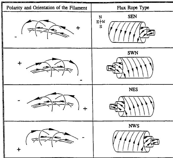
**Slika 3.4.:** Skica konfiguracije magnetskog polja filamenta/prominencije i očekivano ustrojstvo cijevi magnetskog toka (Bothmer i Schwenn, 1994). Radi jednostavnosti se pretpostavlja da magnetsko uže leži u ekliptičkoj ravnini i npr. oznaka SEN znači zakretanje vektora magnetskog polja od juga (S) prema sjeveru (N) s ukupnim usmjerenjem prema istoku (E); Sukladno tome, vrijedi i za npr. SWN gdje W označava zapad.
