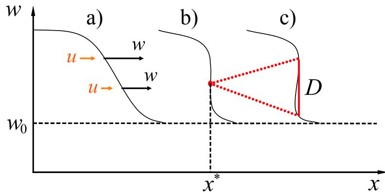
**Slika 3.23.:** Shematski prikaz stvaranja udarnog vala u jednodimenzionalnom slučaju. Fazna brzina vala  $w(t)$  povezana je s brzinom toka plazme  $u(t)$ . (a) valna fronta u početnom trenutku se nelinearno ustrmljava; (b) pojavljuje se diskontinuitet  $D$  na položaju  $x^*$ ; (c) udarni val se nastavlja gibati (Žic et al., 2008).
