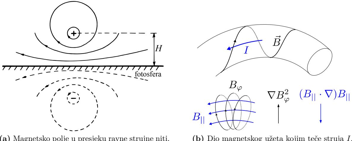
(a) Magnetsko polje u presjeku ravne strujne niti.
