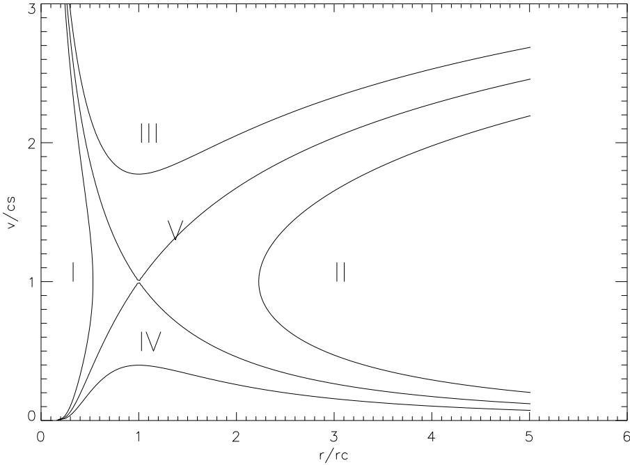
**Slika 5.3.:** Ovisnost brzine Sunčevog vjetra  $v$  o radijalnom položaju  $r$  za pet različitih vrijednosti konstante  $C$ . Brzina je normirana na brzinu zvuka  $c_s$ , a radijalni položaj s obzirom na kritičnu vrijednost  $r_c$  (Koskinen i Vainio, 2011).
