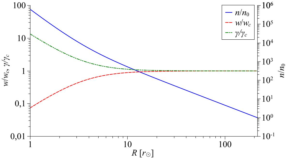
**Slika 5.11.:** Logaritamska ovisnost omjera gustoće  $n/n_0$  (s obzirom na gustoću  $n_0$  pri 1 AU), te omjera brzine Sunčevog vjetra  $w/w_c$  i omjera funkcije „otpora“  $\gamma/\gamma_c$ , o logaritamskoj udaljenosti  $R$  izražene u Sunčevim polumjerima,  $r_\odot$ . Asimptotske vrijednosti brzine Sunčevog vjetra i funkcije „otpora“ označene su redom s  $w_c$  i  $\gamma_c$ .
