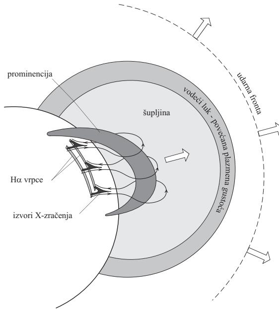
**Slika 2.7.:** Skica standardnog modela trodijelne strukture CME-a ili eruptivnog bljeska prema (Forbes, 2000). Prominencija i pripadajuća magnetska arkada bubre u niskoj koroni, nakon čega se aktivira rekonekcijski proces i zapaža dvovlakasti H $\alpha$  bljesak u podnožju arkade.
