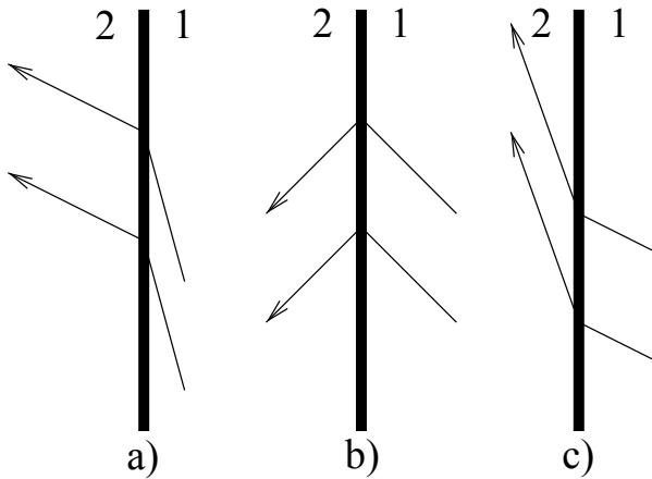
**Slika 3.22.:** Promjena magnetskog polja pri naletu udarnog vala ( $1 \rightarrow 2$ ) u sustavu u kojem granica diskontinuiteta miruje. Udarni valovi se dijele na: (a) spore udarne valove, (b) Alfénove ili intermedijарne udarne valove, (c) brze udarne valove, ovisno o tome kako mijenjaju magnetsko polje.
