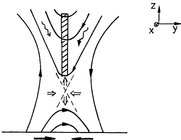
**Slika 4.5.:** Dvodimenzionalni prikaz magnetskog prespajanja u strujnoj plohi ispod prominencije. Prikazan je pritok plazme u strujnu plohu i njen izlazni tok (Vršnak, 1992).
