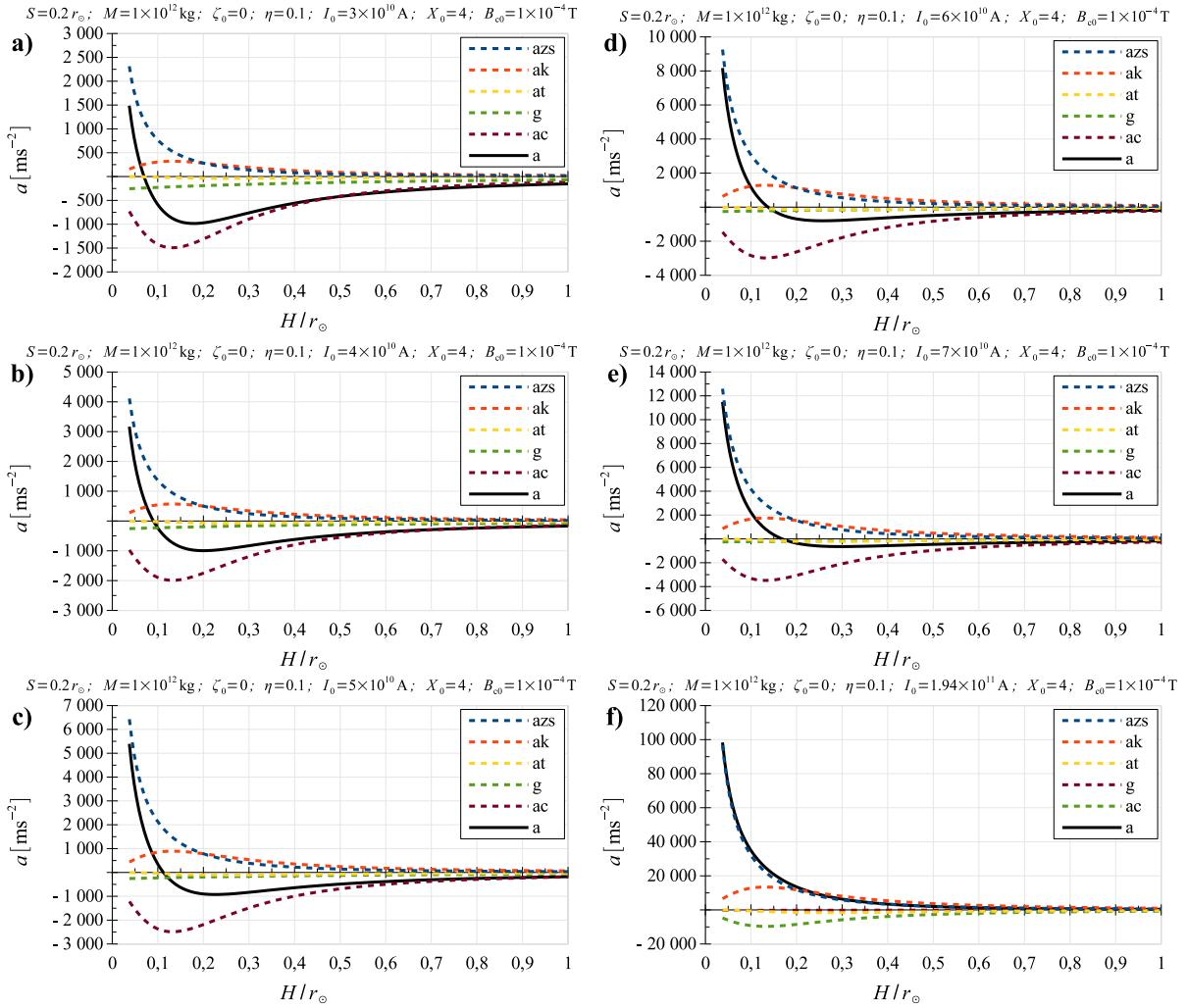
**Slika 4.26.:** Ubrzanje  $a$  torusne strukture prikazano je u ovisnosti o visini njegovog vodećeg luka  $H/r_\odot$ , podijeljenog s polumjerom Sunca  $r_\odot$ , za različite struje  $I_0$ , dok u zadnjoj podslici dolazi do gubitka ravnoteže. U modelu se ne koristi sila MHD otpora. Ravnotežni položaj  $H_{\text{eq}}/r_\odot$  (određen s uvjetom  $a = 0$ ) povećava se kako raste struja  $I_0$ .
