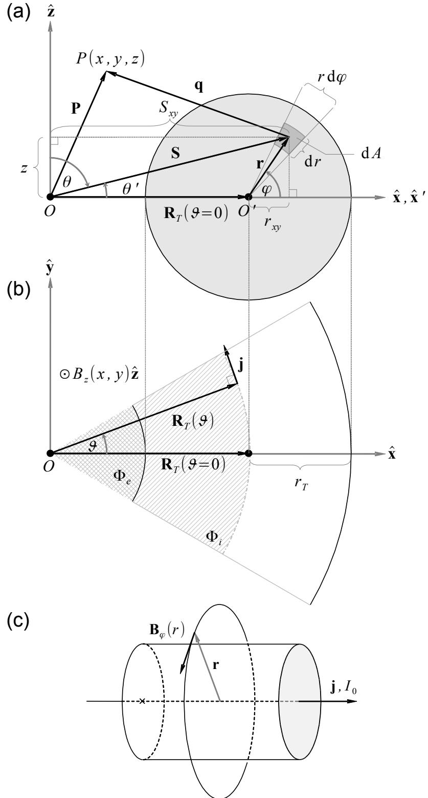
**Slika 4.15.:** Prikazan je poprečni presjek torusa u: (a)  $xz$ -ravnini; (b)  $xy$ -ravnini.  $\hat{x}$ ,  $\hat{y}$ , i  $\hat{z}$  su jedinični vektori i definiraju osi osnovnog kordinatnog sustava. (c) Torusni segment i prikaz poloidalnog magnetskog polja  $B_\varphi$  i gustoće struje  $\mathbf{j}$ , te ukupne struje  $I_0$  koja teče torusom.
