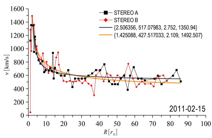
**Slika 5.12.:** Primjeri određivanja ulaznih parametara općenitog modela MHD otpora minimizacijom kvadratnog odstupanja s obzirom na eksperimentalne podatke dobivene STEREO-A i B satelitima. Vrijednosti ulaznih parametara  $\{\Gamma, w_c [\text{km/s}], R_0 [r_\odot], v_0 [\text{km/s}]\}$  dani su u legendama svake podslike.
