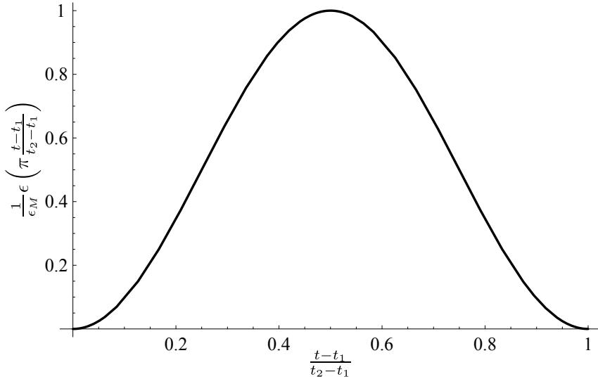
**Slika 4.23.:** Na slici je prikazana modelirana funkcija pojačanja  $\epsilon(\zeta)$  struje  $I_0$ . Zbog dodatnog magnetskog toka  $\Delta\Phi_e$  inducira se struja  $\Delta I(\zeta) = \epsilon(\zeta)I_0$ .
