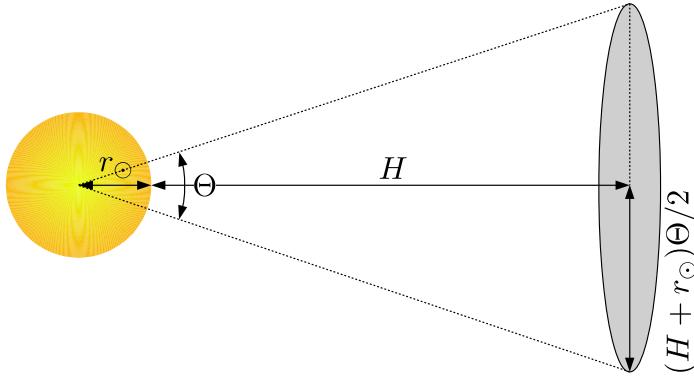
**Slika 4.25.:** Stožasti model s obzirom na središte Sunca. U stožastom modelu polumjer Sunca je označen je s  $r_{\odot}$ , visina torodialnog segmenta s  $H$ , a efektivna površina iznosi  $A \approx \frac{\pi}{4}(H + r_{\odot})^2\Theta^2$  (Xie et al., 2004; Vršnak et al., 2007).
