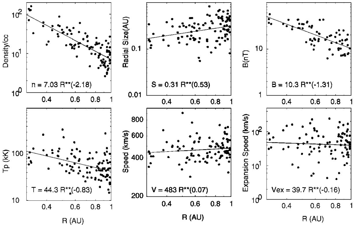
**Slika 3.5.:** Promjena srednjih vrijednosti fizičkih značajki ICME-a s heliocentričnom udaljenosti. Podaci su dobiveni Helios 1/2 satelitom tijekom 1975-1980. godine i prikazani su u log-log skali (Forsyth et al., 2006).
