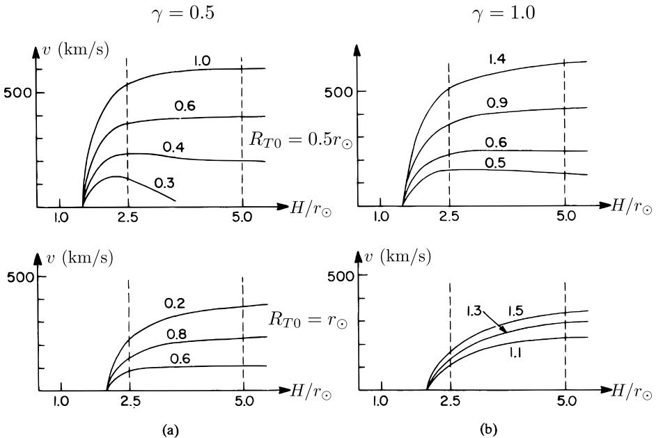
**Slika 4.13.:** Izračunate ovisnosti brzine vršnog segmenta strujne petlje o visini prema Anzer (1978) modelu: (a) za vrijednost parametra  $\gamma = 0.5$  i dvije različite početne vrijednosti  $R_{T0} = 0.5r_\odot$  i  $R_{T0} = r_\odot$  gdje iznad svake krivulje nalazi vrijednost konstante  $k$ . (b) slično kao i u prethodnoj slici samo je  $\gamma = 1.0$ .
